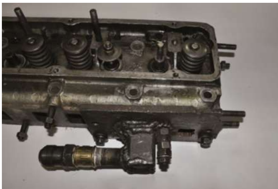
Рисунок 3.5 – Головка циліндрів і впускний трубопровід у зборі
