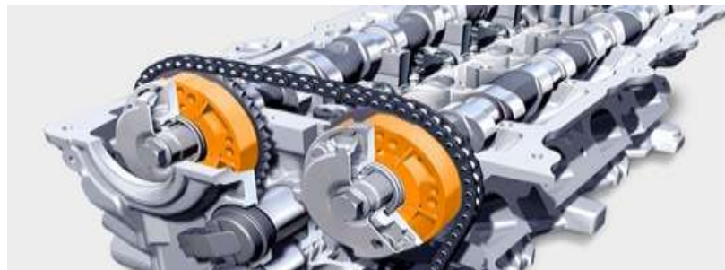
Рисунок 1.1 – Система Vanos (із безступеневим регулюванням кутового положення розподільного вала)
