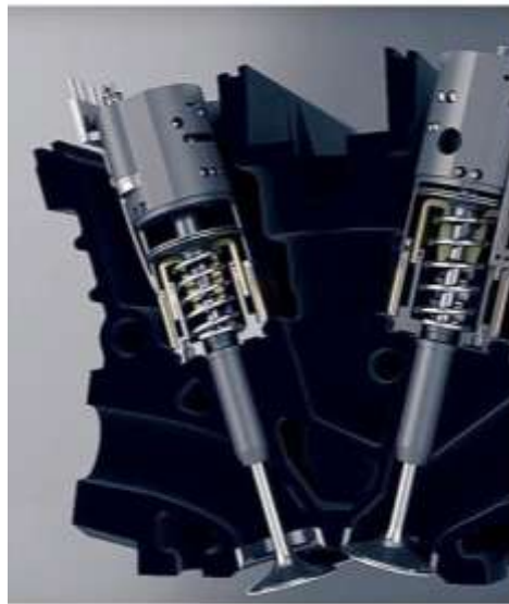
Рисунок 1.5 – Клапани з електромагнітним приводом
