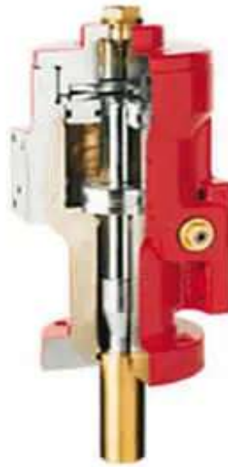
Рисунок 1.6 – Газорозподільний механізм ДВЗ з гідравлічним приводом
