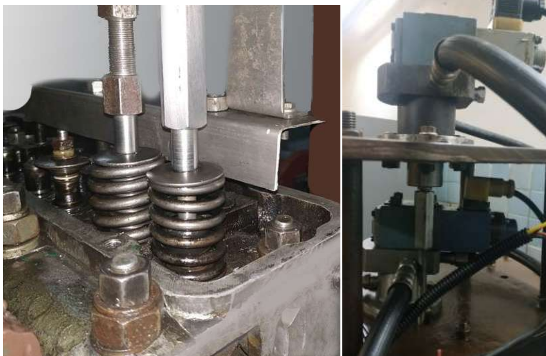
Рисунок 3.7 – Одноциліндровий відсік ПД з електрогідроприводом двох клапанів
