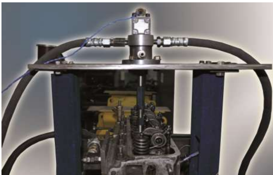
Рисунок 3.6 – Одноциліндровий відсік ПД з комбінованим приводом ГРМ
