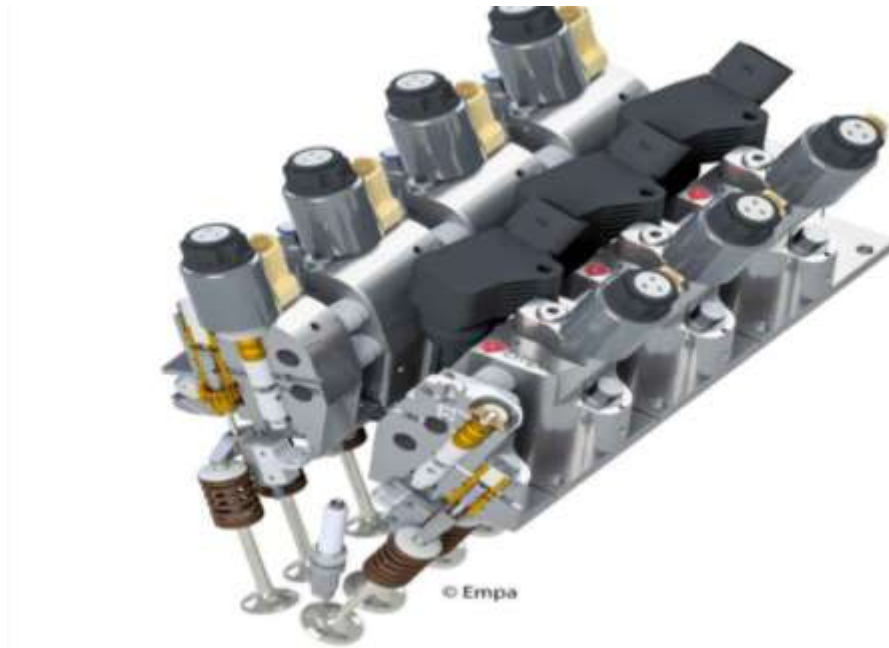
Рисунок 1.8 – Перспективна електромагнітна система приводу клапанів Valvetronic
