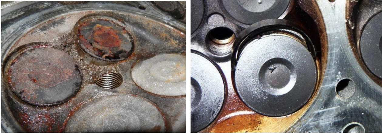
Рисунок 21 – Пошкодження камери згоряння: а – сліди плавлення стінки між сідлами випускних клапанів; б – випадання сідел при перегріві від швидкої втрати охолоджуючої рідини
