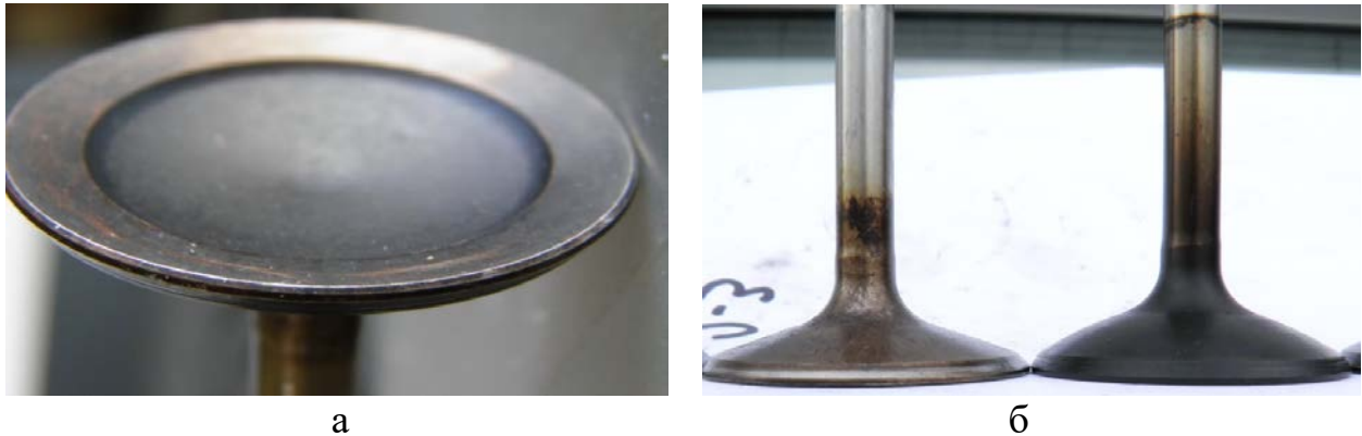
Рисунок 23 – Деформація головки одного із впускних клапанів: а – вигляд класичного "тюльпана"; б – повна відсутність пошкоджень розташованого поруч сусіднього впускного клапана в тому ж циліндрі.
