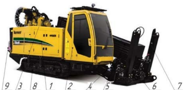
Рисунок 1.4 – Установка ГНБ фірми Vermeer: 1 – силова установка з рамою; 2 – кабіна оператора; 3 – привід бурових штанг; 4 – направляюча рама приводу бурових штанг; 5 – ключі з гідроприводом для розкручування штанг; 6 – магазин штанг; 7 – анкерні пристрої; 8 – ходове обладнання; 9 – помпа подачі бурової рі-
