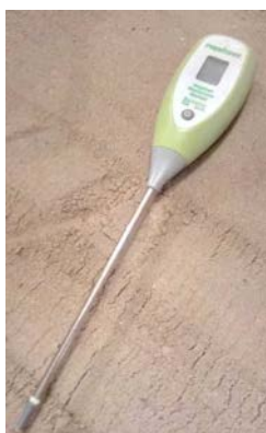
Рисунок 3.10 – Прилад для вимірювання вологи - цифровий вологомір ґрунту Rapitest 1825
