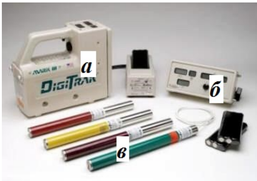
Рисунок 3.17 – Загальний комплект локаційної системи DigiTrakMark III: а) – локаційна система, б) – повторювач сигналу, в) – зонд використовується в залежності від глибини прокладання пілотного отвору та типу ґрунту на поверхні
