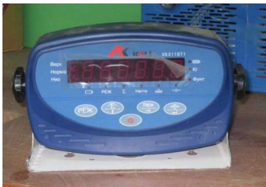
Рисунок 3.6 – Ваговий термінал типу ХК3118Т1
