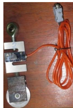
Рисунок 3.7 – Тензодатчик Keli DEF 750
