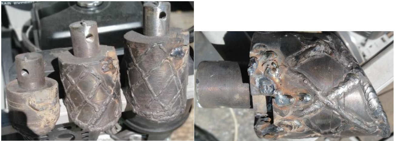
Рисунок 3.15 – Косий наконечник з великим кутом загострення (близько 60 град) для твердих суглинкових та супісчаних ґрунтів, фото
