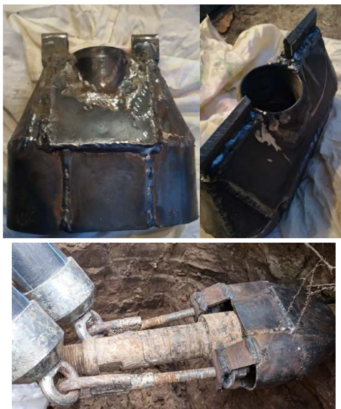
Рисунок 3.14 – Клиново-призматичні РО для 2 та 3 футлярів діаметром 90 мм, фото
