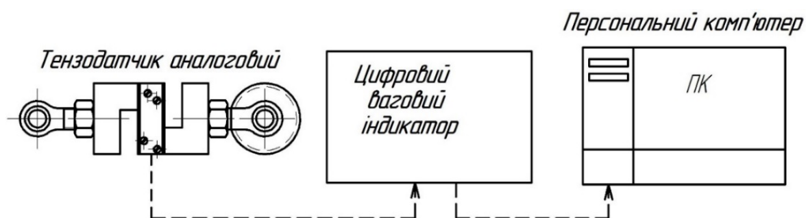
Рисунок 3.9 – Принципова схема вимірювального вузла
