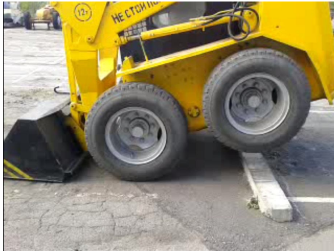
Рисунок 1.1 – Відрив задніх коліс під час подолання навантажувачем одиначної перешкоди
