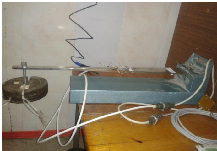
Рисунок 4.3 – Балка для калібрування тензометричних мостів
