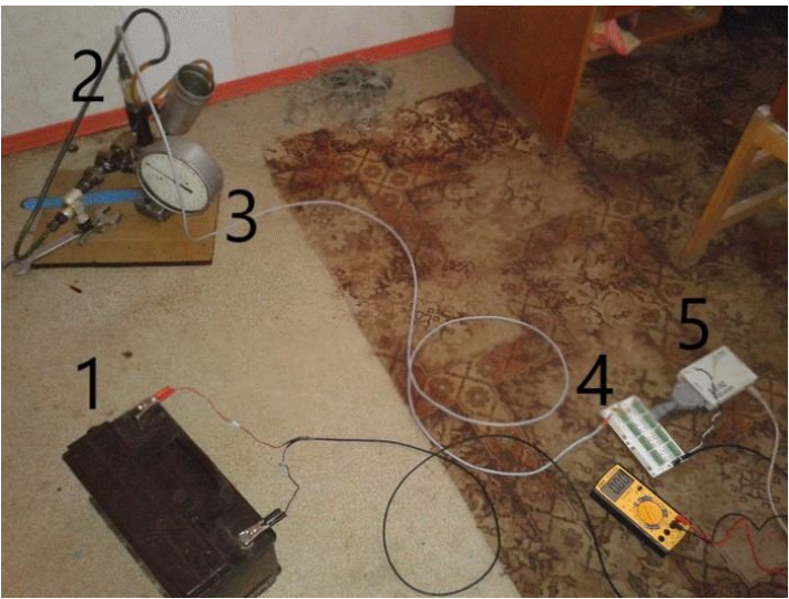
Рисунок 4.9 – Калібрування датчика тиску на ручній насосній станції
