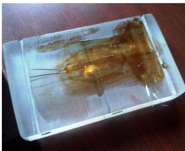
Рис. Е.7 – Зображення виготовленої пластини з наклеєними тензодатчиками
