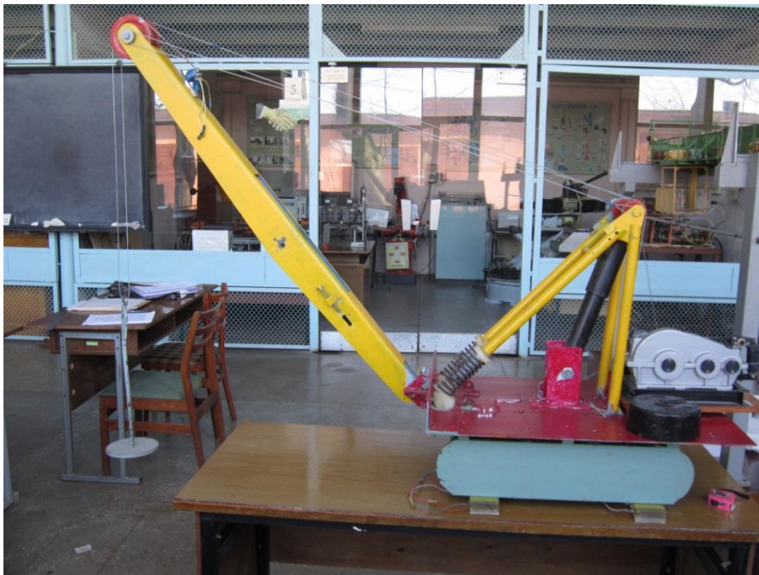
Рис. 3.9 – Фізична модель стрілового гусеничного крану для дослідження динамічних навантажень
