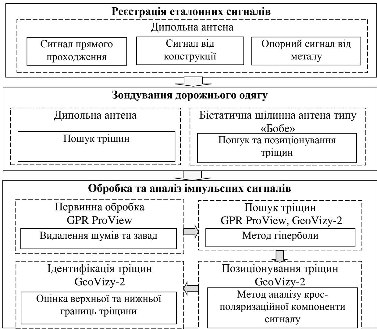
Рисунок 3.5 – Порядок отримання георадарних даних та їх інтерпретації
