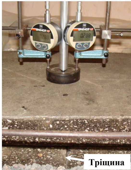
Рисунок 3.29 – Модель для вимірювання переміщень під навантаженням
