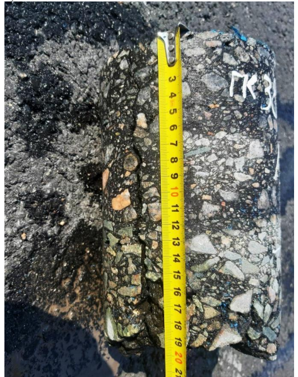
Рисунок 3.9 – Обстеження дорожнього одягу на ділянці від ПК 33+00 до ПК 39+00: а) георадарне сканування дорожнього одягу; б) дослідження на ділянці з тріщиною; в) керн на ПК 33+50; г) керн на ПК 38+60
