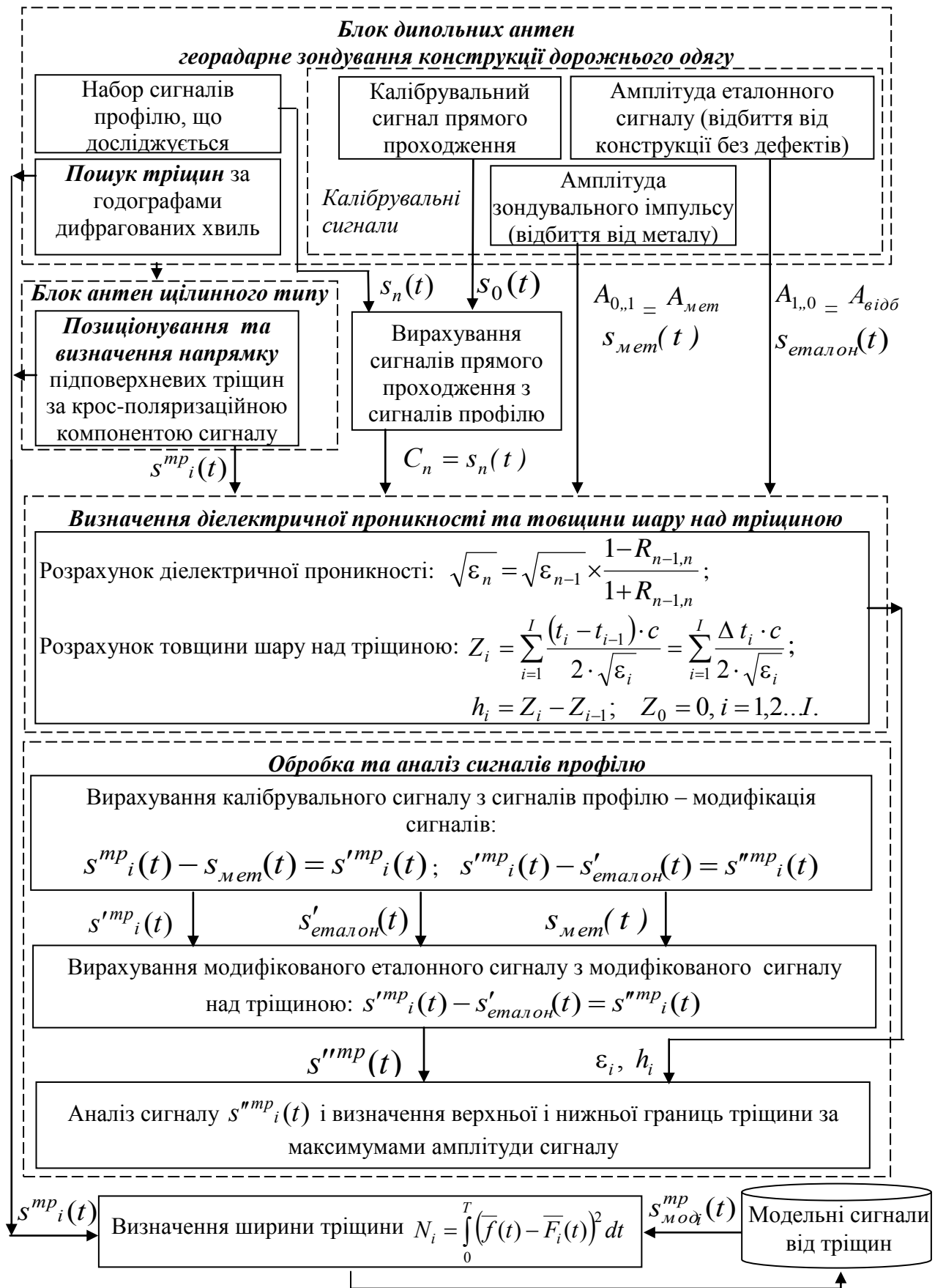
Рисунок 2.3 – Схема алгоритму обробки імпульсних сигналів при вирішенні задач пошуку, позиціонування та ідентифікації тріщин
