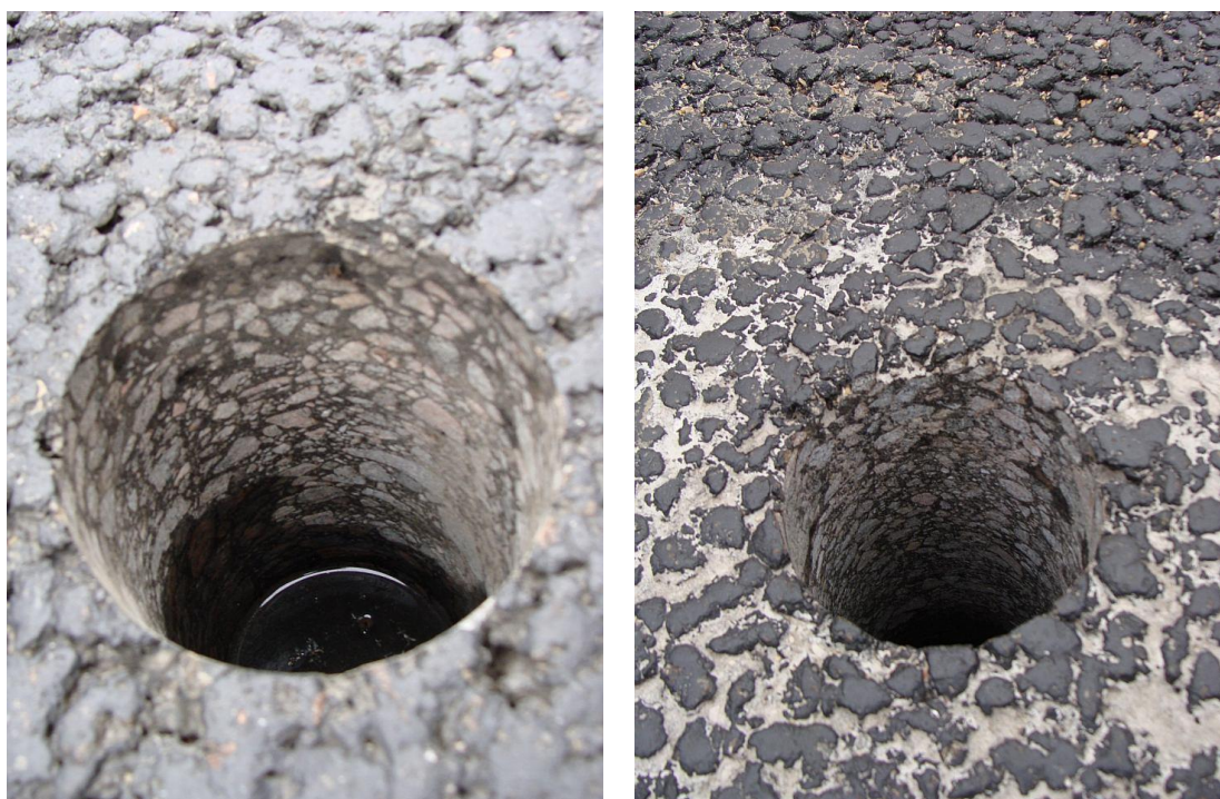
Рисунок Б.1 – Свердловини, що використовувалися для калібрування антенних блоків
