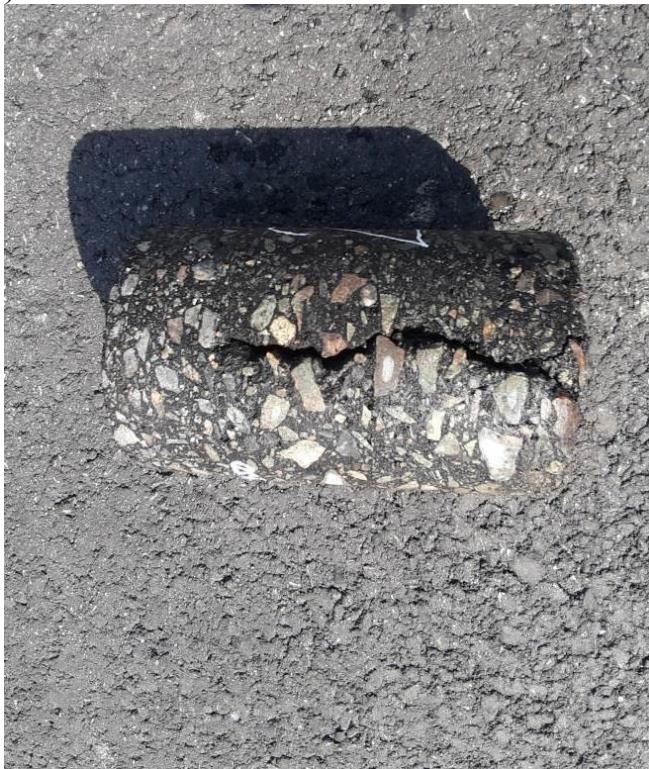
Рисунок 3.9 – Обстеження дорожнього одягу на ділянці від ПК 33+00 до ПК 39+00: а) георадарне сканування дорожнього одягу; б) дослідження на ділянці з тріщиною; в) керн на ПК 33+50; г) керн на ПК 38+60
