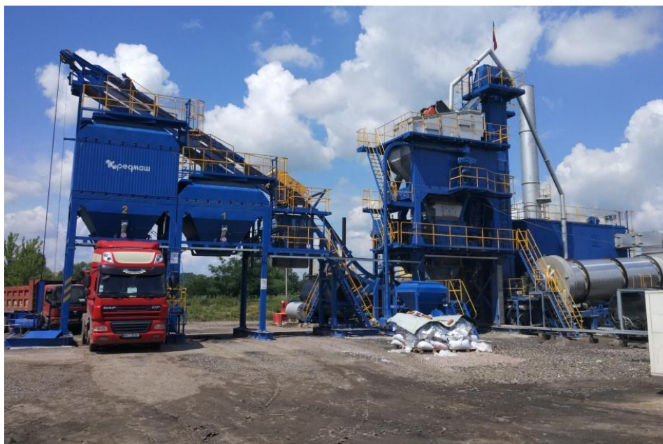
Рис. 5.1 – Асфальтозмішувальна установка ДС-168
