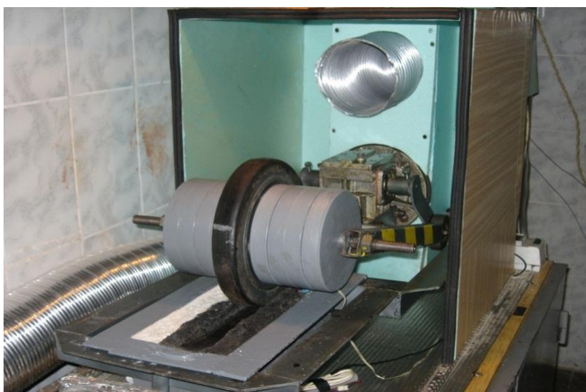
Рис. 3.2 – Прилад-коліємір конструкції кафедри будівництва і експлуатації автомобільних доріг ХНАДУ
