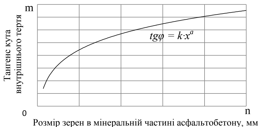
Рис. 2.1 – Залежність тангенса кута внутрішнього тертя від розміру зерен в мінеральній частині щебенево-мастикового асфальтобетону
