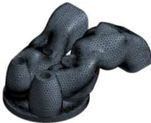
Рисунок 2.36. Розрахункова сітки, що описує конфігурацію КЗ та впускних і випускних каналів з клапанами дизельного двигуна 16ЧН26/27
