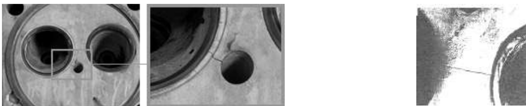
Рисунок 1.27. Характерні експлуатаційні дефекти головок форсованих дизельних двигунів
