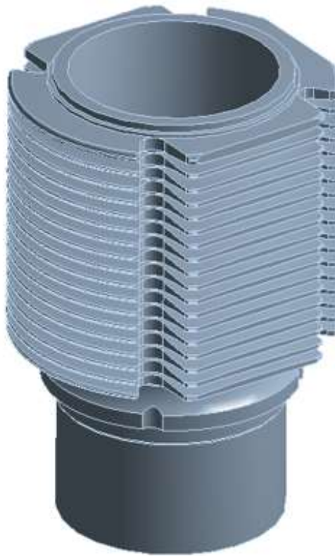
Рисунок 3.1. Геометрія циліндра двигуна 2Ч10,5/12
