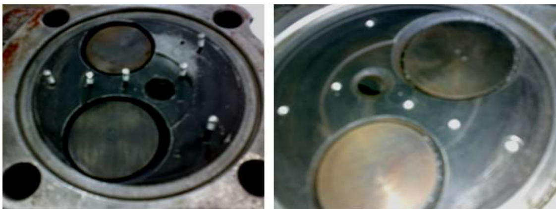
Рисунок 5.11. Фото встановлених термопар у вогневе днище головки циліндра
