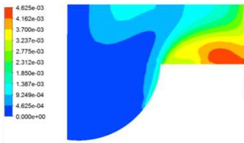
Рисунок 6.22. Розподіл масової частки \text{NO}_x в циліндрі дизельного двигуна 2Ч10,5/12 (400 град. п.к.в., режим з N_e = 9,2 кВт при n = 1800 хв ^{-1} )
