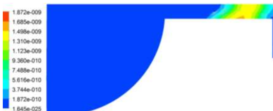
Рисунок 6.28. Розподіл об'ємної частки твердих частинок у циліндрі НССІ двигуна 2Ч10,5/12 (370 град. п.к.в., режим з N_e = 18,4 кВт при n = 1800 хв -1 )
