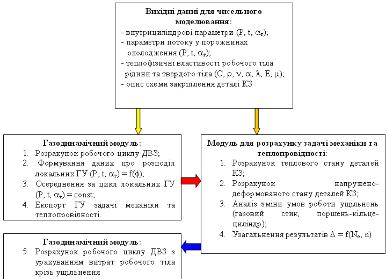
Рисунок 2.3. Блок-схема з етапами розв'язання спряженої задачі термогазодинаміки
