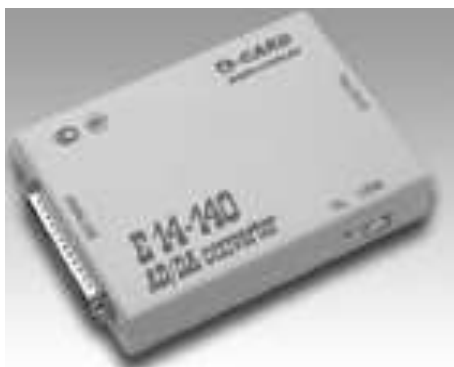
Рисунок 5.15. Зовнішній вигляд АЦП, який використовувався для перетворення та передачі сигналу до персонального комп'ютеру [287]
