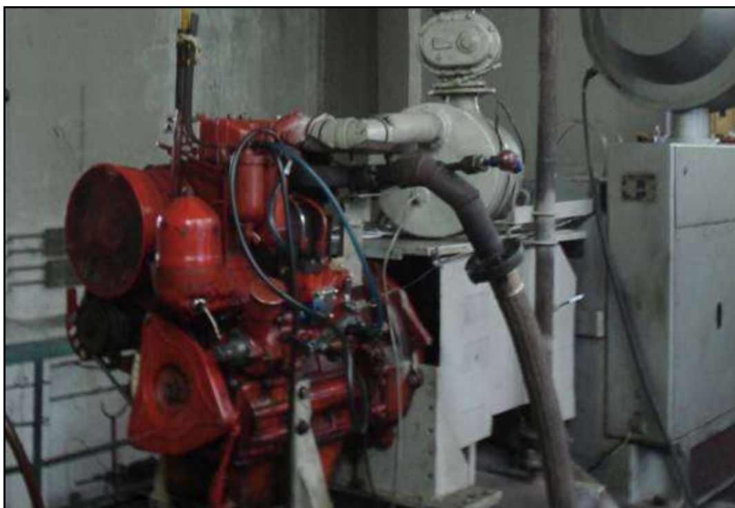
Рисунок 5.1. Моторний дослідний стенд з двигуном 2Ч10,5/12
