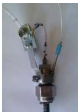
Рисунок 5.12. Загальний вигляд датчика тиску
