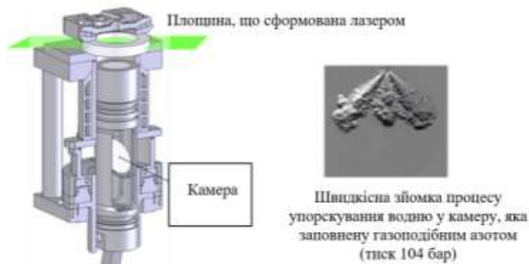
Рисунок 1.29. Загальний вигляд безмоторного стенда для дослідження процесу формування паливного факела (швидкісна зйомка)
