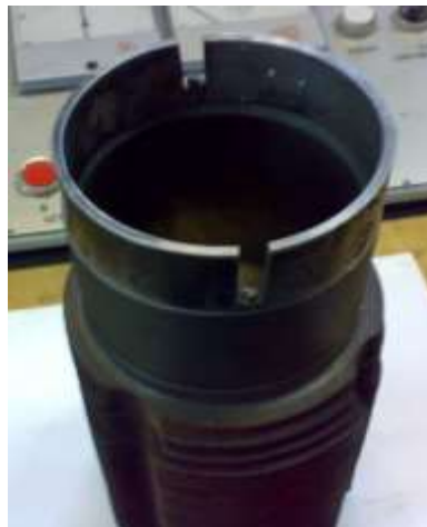
Рисунок 5.9. Циліндр зі встановленою сталеву проставкою для кріплення контактної колодки – передачі сигналу від термопар розташованих у поршні
