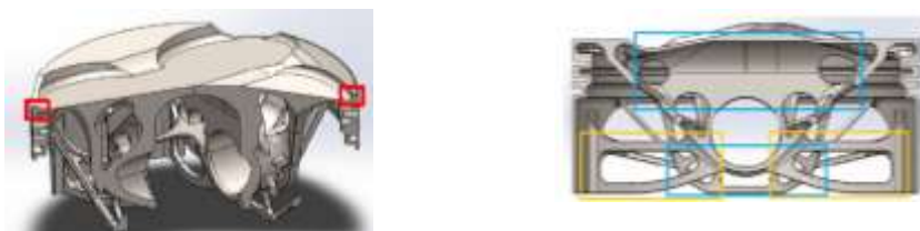
Рисунок 1.24. Приклад конструкції тонкостінних сталевих поршнів для двигуна Отто [173]
