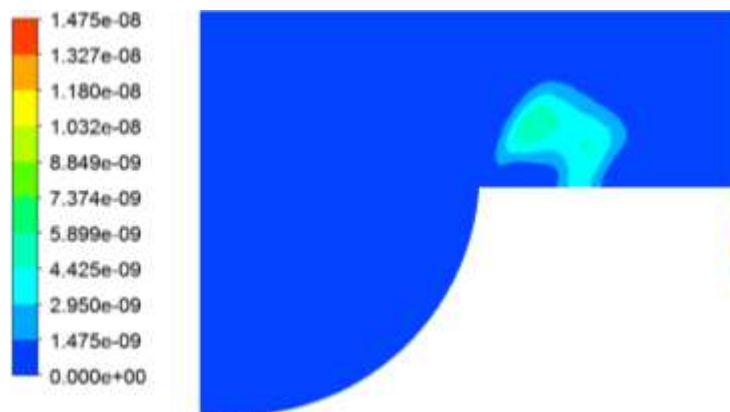
Рисунок 6.31. Розподіл об'ємної частки твердих частинок у циліндрі дизельного двигуна 2Ч10,5/12 (400 град. п.к.в., режим з N_e = 9,2 кВт при n = 1800 хв -1 )
