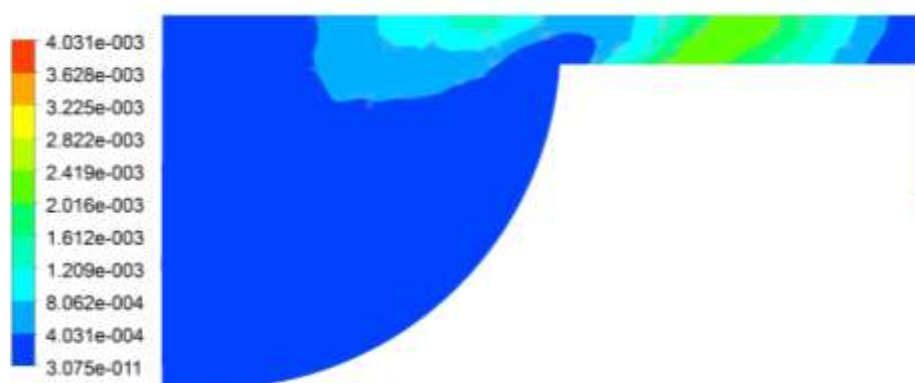
Рисунок 6.19. Розподіл масової частки \text{NO}_x в циліндрі НССІ двигуна 2Ч10,5/12 (370 град. п.к.в., режим з N_e = 18,4 кВт при n = 1800 хв ^{-1} )
