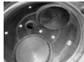
Рисунок 13 – Фото встановлених термопар у вогневе днище головки циліндра
