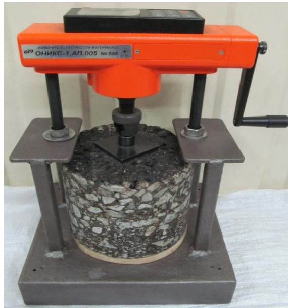
Рисунок 3.5 – Прилад адгезиметр ОНИКС-1.АП з удосконаленою опорною конструктивною частиною для визначення зусилля відриву
