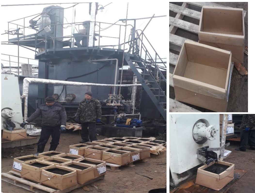
Рисунок 5.16 – Загальний вигляд виробничого вузла об'єднання складників бітумно-полімерних герметизуючих матеріалів та процесу розфасовування герметика і мастики
