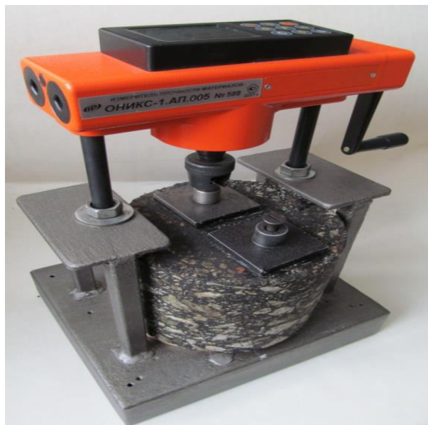
Рисунок 3.8 – Прилад ОНИКС-1.АП, приведений у робоче положення
