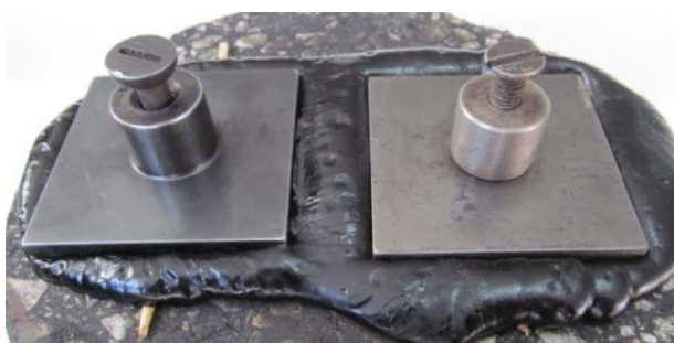
Рисунок 3.6 – Загальний вигляд зразка із закріпленими на поверхні мастики металевими штампами
