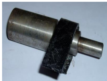
Рисунок 3.2 – Загальний вигляд зразка під час визначенні показника гнучкості герметизуючого матеріалу
