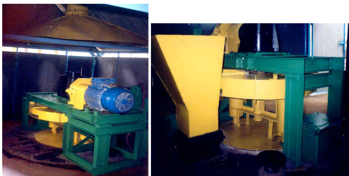
Рисунок 5.5 – Загальний вигляд планетарного механізму мішалки
