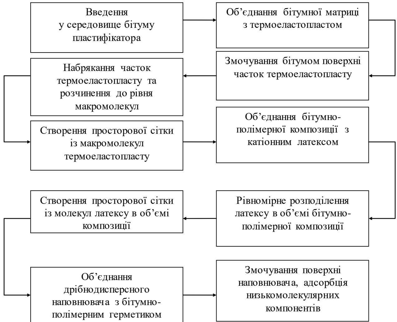
Рисунок 2.1 – Схема процесу об'єднання складників бітумно-полімерної герметизуючої мастики шляхом перемішування
