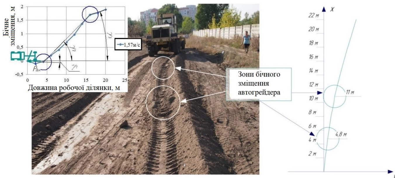
Рисунок 2.2. Траєкторія руху машини з прямолінійних ділянок, повернутих одна до одної в процесі різання ґрунту
