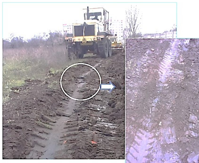
Рисунок 3.6. Фотограма процесу бокового зміщення машини в ході проведення експерименту
