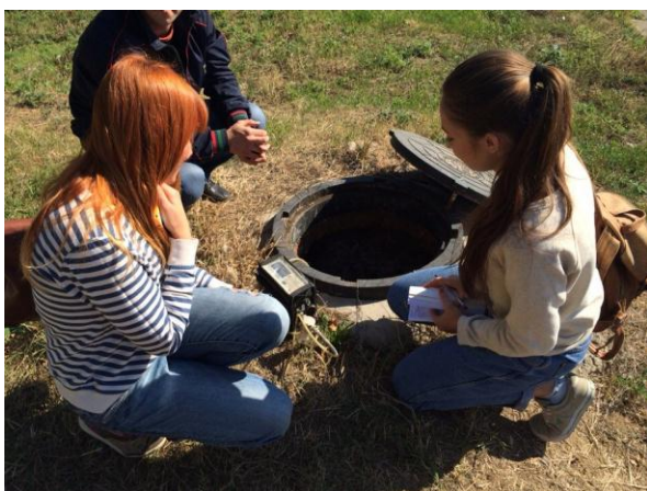
Рисунок 2.2 – Проведення вимірювань концентрацій небезпечних газоподібних речовин на контрольних шахтах
