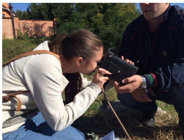
Рисунок 2.2 – Проведення вимірювань концентрацій небезпечних газоподібних речовин на контрольних шахтах
