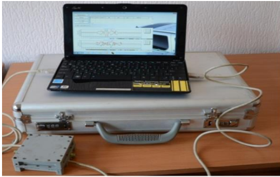
1- установочный блок, 2 - коромисло, 3 - рамка, 4 - регулировальные винты коромисла, 5 - рамка, 6 - датчики прискорення
