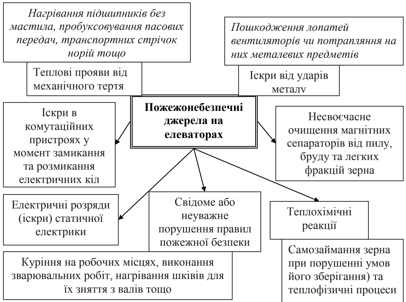
Рис. 1.3. Потенційні пожежонебезпечні джерела у виробничих приміщеннях елеватора
