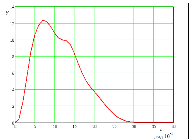
Рис.10 Зміна швидкості накопичення вологи в тришаровому матеріалі на основі мікромоделі
