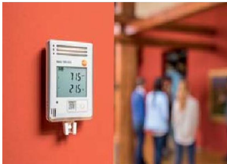
Рис 2. Прилади для безперервного вимірювання CO 2 Безперервно вимірюють температуру, вологість та CO 2 (рис 2). Отримані значення передаються по бездротовій локальній мережі на хмарний
