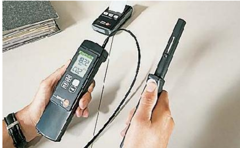
Рис 1. Портативні прилади придатні для довготривалих вимірювань портативні прилади придатні для довготривалих вимірювань швидко і точно виміряють вміст CO 2 (рис.1).
