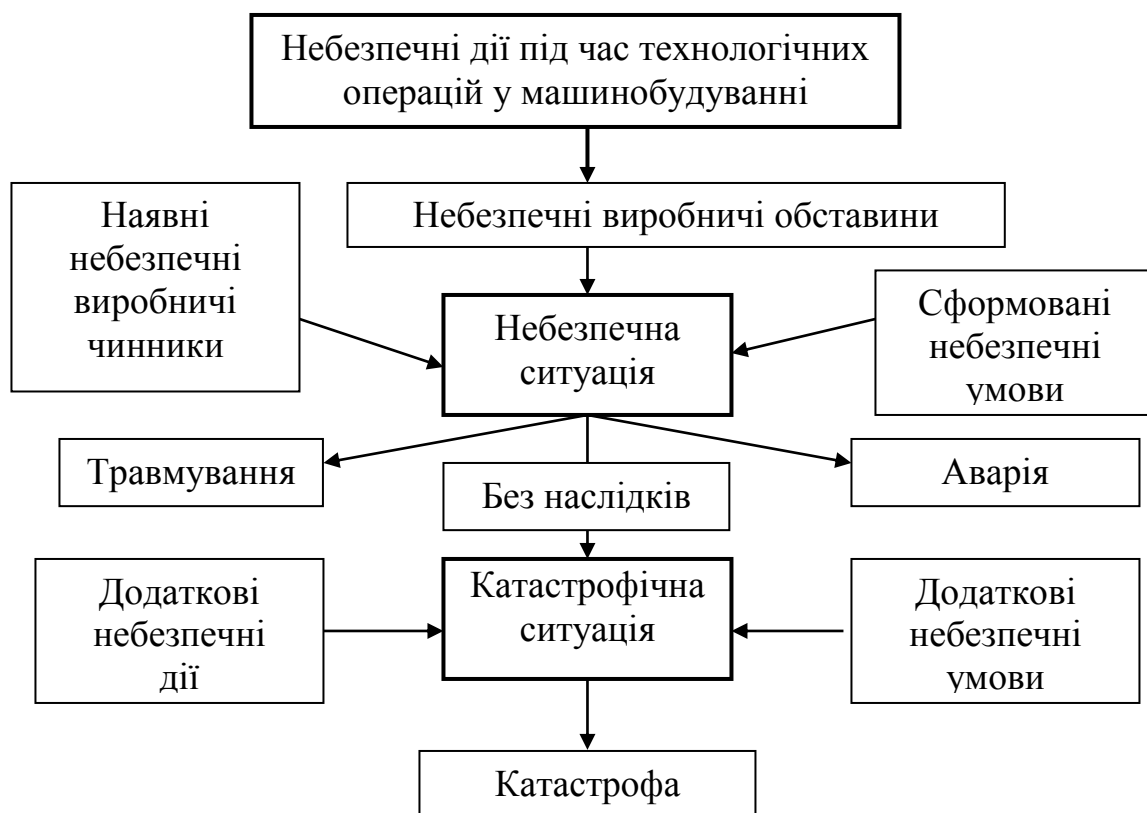
Рис. 2.1. Аналітична блок-схема процесу утворення небезпечних, аварійних та катастрофічних ситуацій у машинобудівній галузі: небезпечний виробничий чинник (НВЧ); небезпечні умови, дії, обставини, ситуації (НУ, НД, НО, НС); аварія (А); травма (Т), критична ситуація (КС), небезпечні умови додаткові (НУ д ), небезпечні дії додаткові (НД я ), катастрофа (К).
