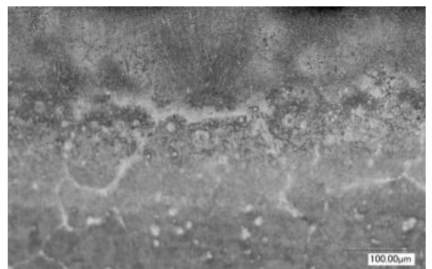
Рисунок 3.2 - Мікроструктура сталі Р6М5К5 після лазерного опромінення при q = 1,3 \cdot 10^4 \text{ Вт / см}^2 , V = 10 \text{ мм / с} : а) ЗЛВ, \times 100 ; б) зона оплавлення поверхневого шару, \times 1000 ; в) зміцнена зона, \times 1000 ; г) перехідна зона, \times 1000
