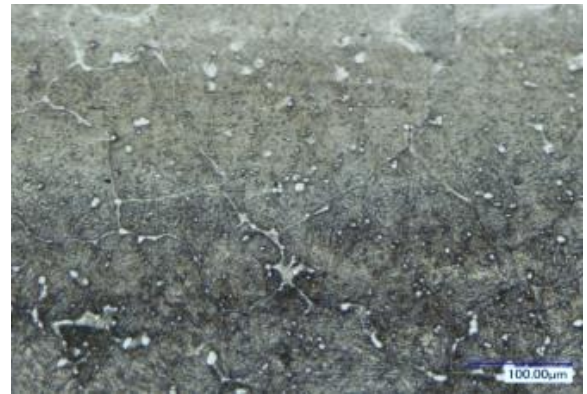
Рисунок 3.3 - Мікроструктура сталі P18 після лазерного опромінення при q = 1,4 \cdot 10^4 \text{ Вт / см}^2 , V = 8 \text{ мм / с} : а) ЗЛВ, \times 100 ; б) зона оплавлення поверхневого шару, \times 1000 ; в) зміцнена зона, \times 1000 ; г) перехідна зона, \times 1000
