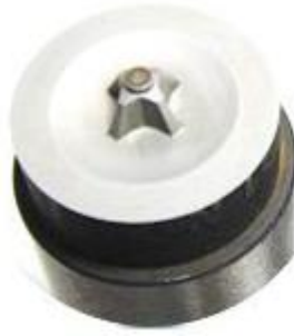
Рисунок 1.3 - Фотографія формотворюючого профілю пуансона видавлювання хрестоподібного шліца
