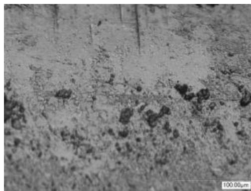
Рисунок 3.4 - Мікроструктура сталі X12M після лазерного опромінення при q = 0,9 \cdot 10^4 \text{ Вт / см}^2 , V = 8 \text{ мм / с} : а) ЗЛВ, \times 100 ; б) зміцнена зона, \times 1000 ; в) перехідна зона, \times 1000
