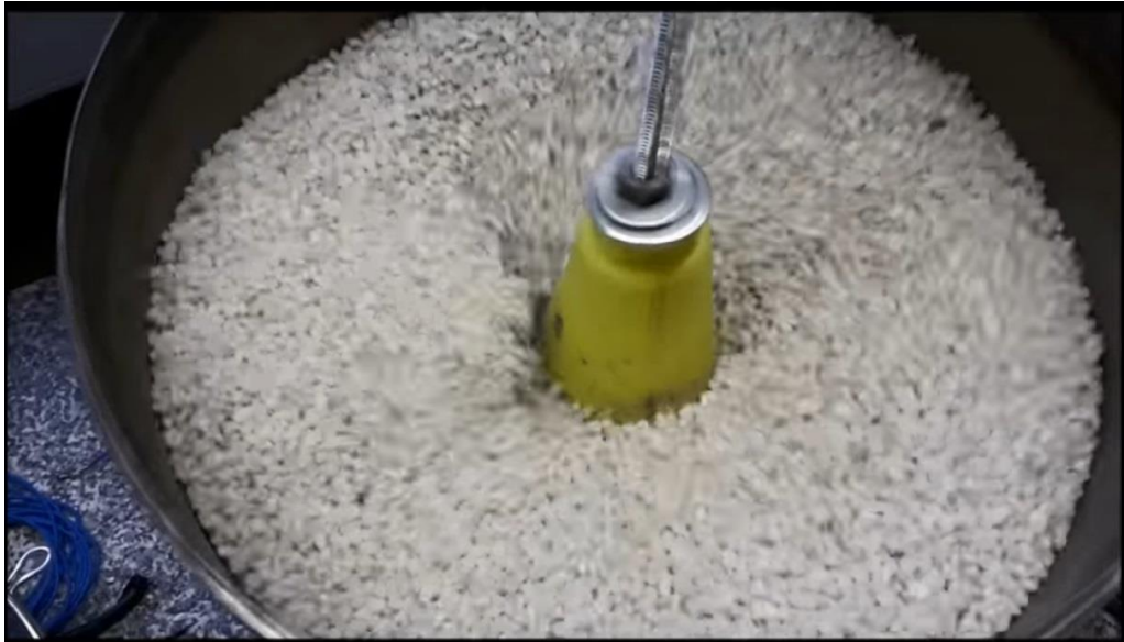
Рисунок 2.9 – Нанесення дисульфиду молібдену за допомогою гранул пінополістиролу
