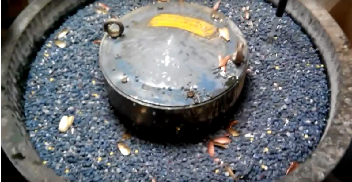
Рисунок 2.4 – Експериментальне дослідження шліфовки бронзових втулок
