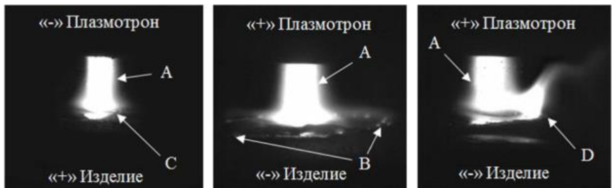
а – струм прямої полярності; б, в – струм зворотної полярності (А-стовп плазми; С – анодна пляма, В – катодні плями; D – стійкий емісійний центр)
