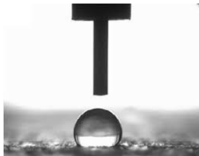
Рис. 3.3— Зображення краплі дистильованої води, що осідає на поверхні композиту.
