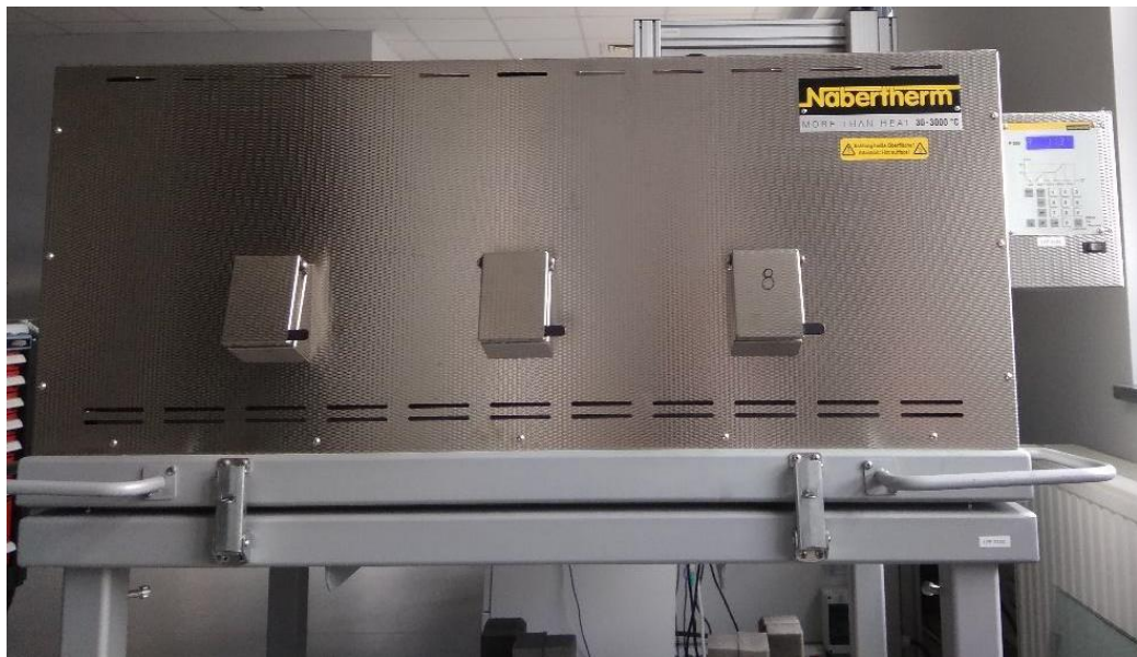
Рис. 2.4 – Плавильна піч GF 240 фірми Nabertherm.
