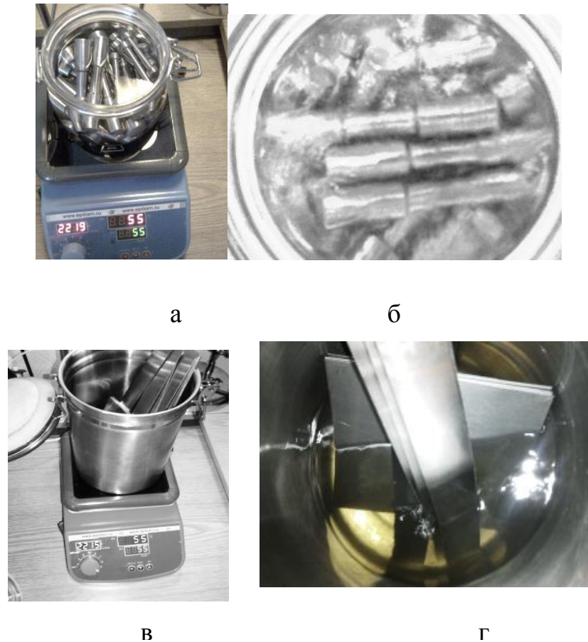
Рисунок 3.1 - Епіламірованіє зразків:: а, б - циліндричних; в, г - плоских
