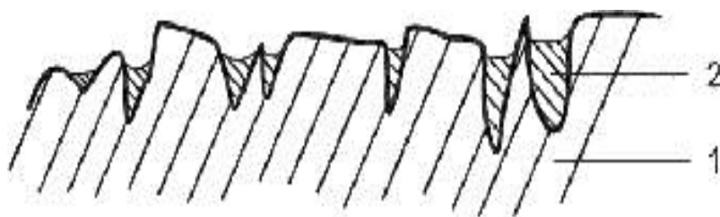
Рисунок 2.2 – Заповнення епіламом мікропор и мікрокапілярів 1 – поверхня твердого тіла, 2 – ПАВ
