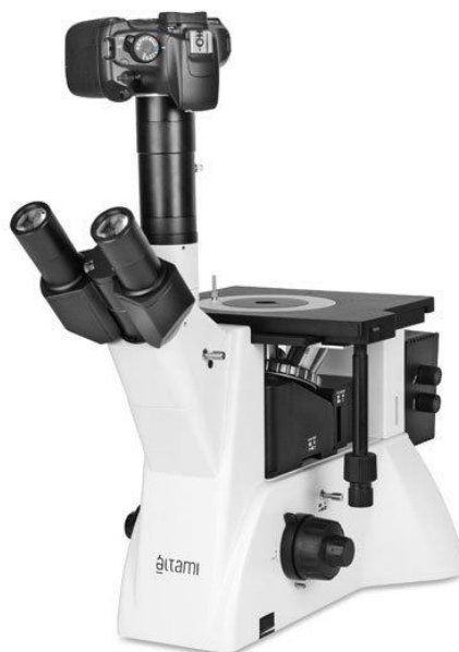
Рисунок 2.3 – Мікроскоп Альтами MET 1
