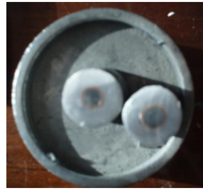
Рисунок 3.2 – Циліндричні штабіки в оболонках після ущільнення вибухом
