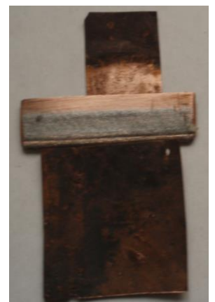
Рисунок 1.4 – Локальне легування сталі та міді наночастками латуні, алюмінію та графіту
