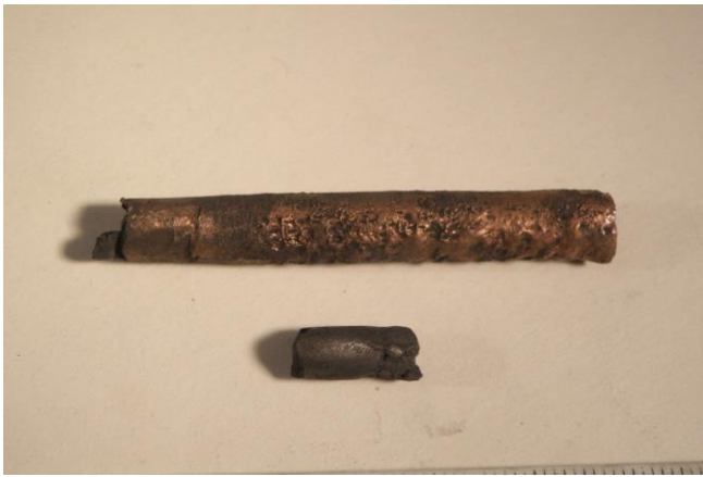
Рисунок 3.2 – Циліндричні штабіки в оболонках після ущільнення вибухом
