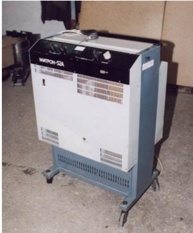
Рисунок 2.2 – Установка «Элитрон – 52 А», призначена для чистового і грубого ЕЕЛ
