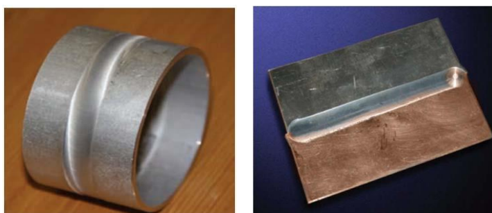
Рис.2 – Трубне з'єднання з алюмінію (а) і зварне з'єднання листів з алюмінієвого сплаву і міді (б)
