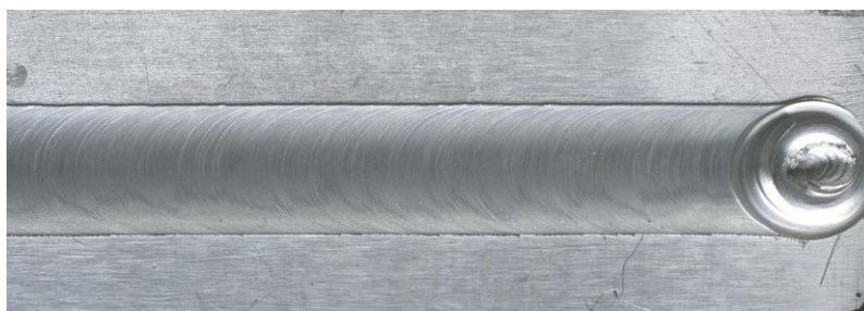
Рис.1.– Загальний вигляд зварного шва ЗТП
