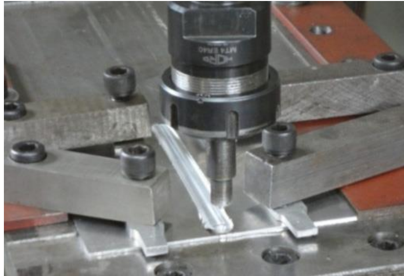
Рис. 19.– Установка для зварювання на базі свердлильного верстата
