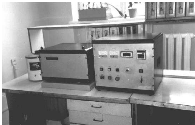
Рис. 5. Прилад для визначення динамічної міцності алмазних порошків типу Фрайтестер
