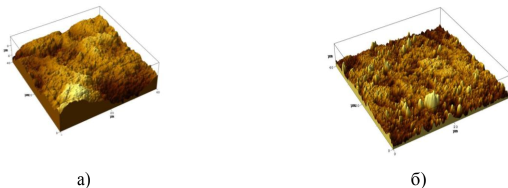
а) - до опромінення ( R_a = 0,1072 мкм), б) - після опромінення плазмою ( R_a = 0,0535 )
