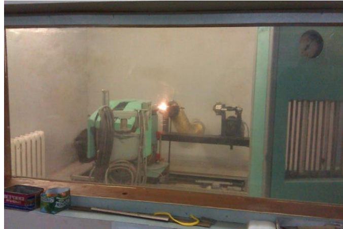
Рисунок 1.2 - Робота установки для детонаційного напилення в Інституті ім. Патона (Київ, Україна, 2012 року)
