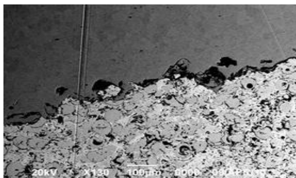
Рисунок 3.10 - СЕМ-зображення (поперечний шліф) кордону з підкладкою покриття з ПГ-19Н-01, покриття внизу
