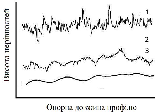
Рисунок 1.2– Профілі поверхні зразків після точіння (1), шліфування (2) та ППД (3)
