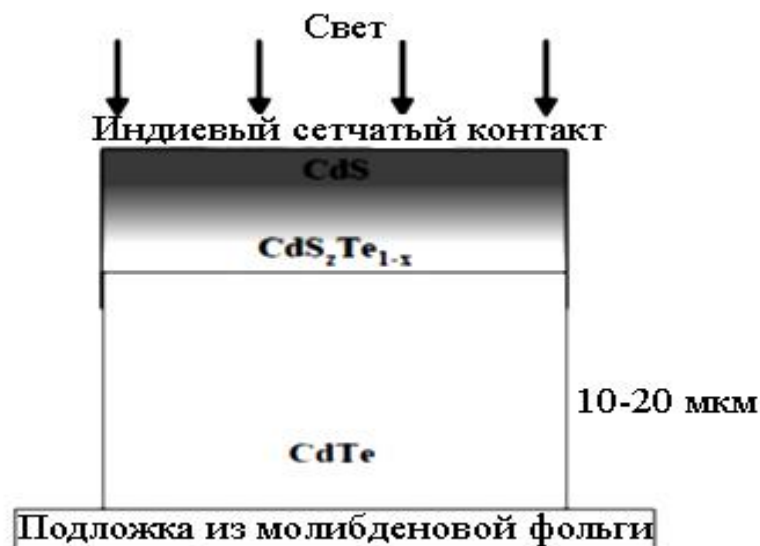
Рис. 1.3 – Конструкція плівкових ФЕП на основі телуриду кадмію фронтальної конфігурації [31]
