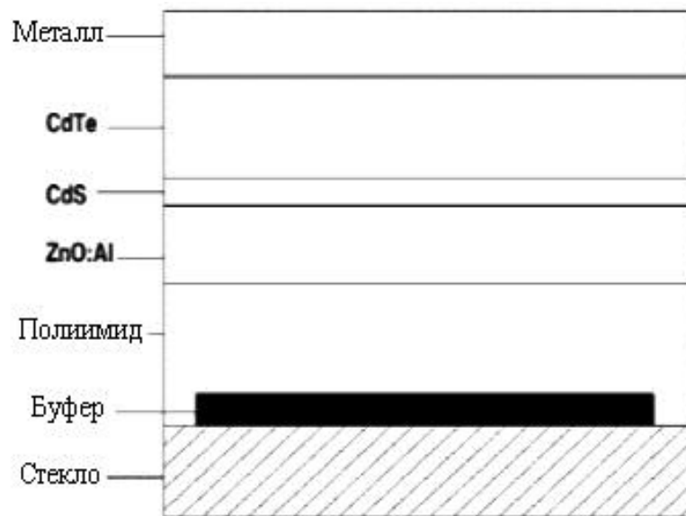
Рис. 1.2 - Конструкція гнучких ФЕП тильній конфігурації [25]
