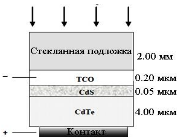
Рис. 1.1 - Конструкція плівкових ФЕП на основі телуриду кадмію тильної конфігурації [22]
