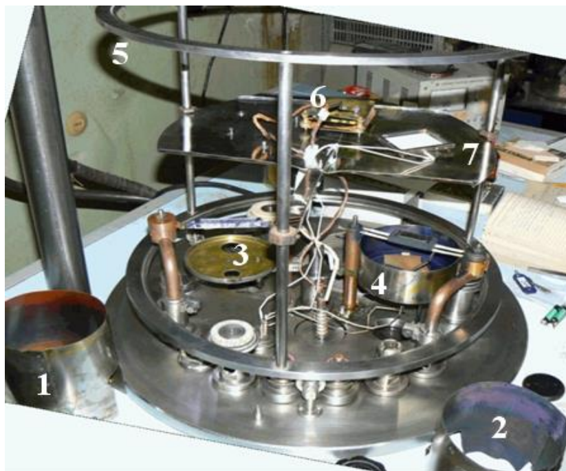
Рис. 2.1. – Внутрішній устрій установки для напылення CdS і CdTe: 1, 2 – екрани 3 – випарник порошкового телуриду кадмію; 4 – випарник порошкового сульфіді кадмію; 5 – карусель, 6 – нагрівач підкладки, 7 – утримувач підкладки
