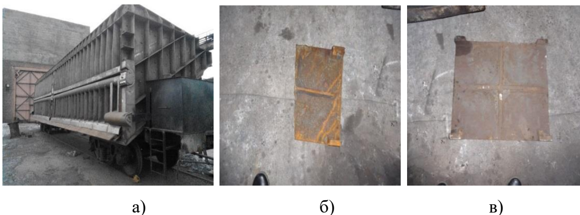
Рисунок 3.3 – Плита коксогасильного вагону зміцнена в умовах СВС а) загальний вигляд вагону, б) плита без покриття(після застосування); в) плита з легованим титаном АП (після застосування)
