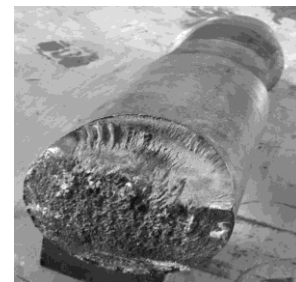
Рисунок 1.4 - Бойок гідромолота (загальний вигляд) і втомне руйнування бойка гідромолота в процесі експлуатації
