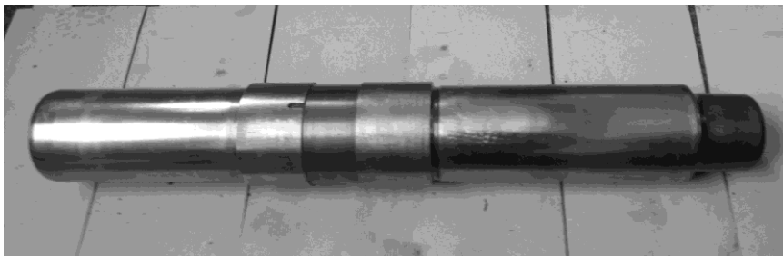
Рисунок 1.4 - Бойок гідромолота (загальний вигляд) і втомне руйнування бойка гідромолота в процесі експлуатації
