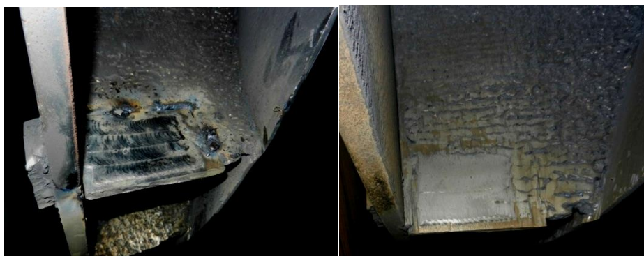
Рисунок 13 – Зліва - пластина з чотирма валиками, нанесеними за допомогою ППН, ввареними в лопатку робочого колеса. Праворуч - зношування після 1 року експлуатації
