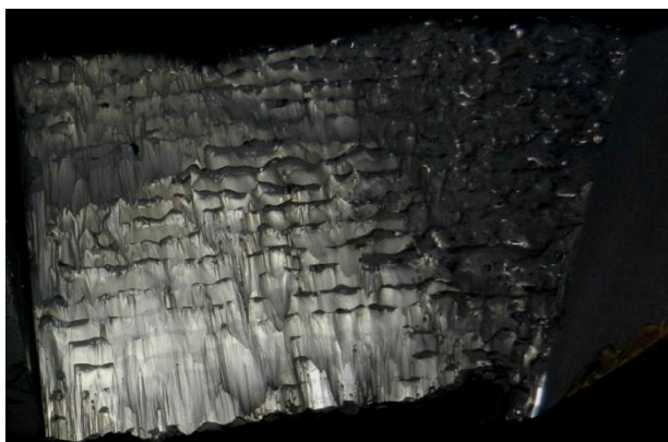
Рисунок 12 - Зношення поверхні лопатці робочого колеса млинового вентилятора, виконаної ручним дуговим наплавленням покритими електродами Т-590, після року експлуатації
