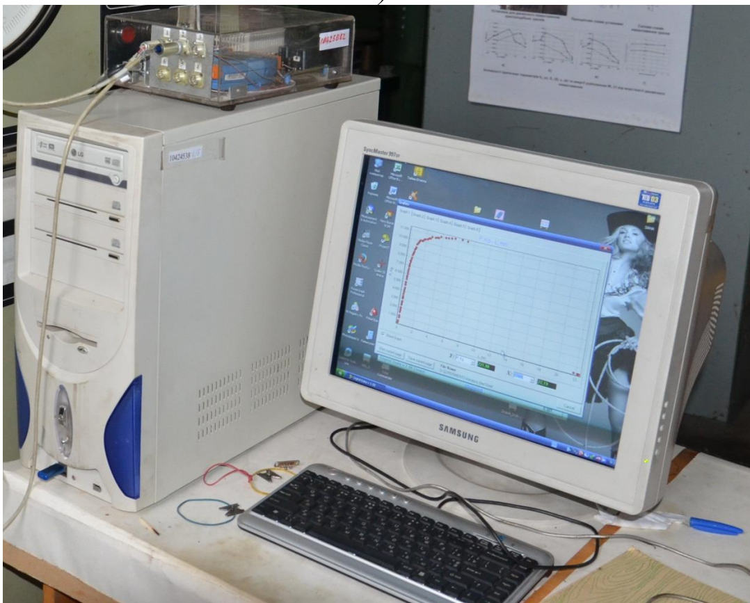
Рис. 12. Осьовий розтяг на розривній машині РМ-25 склеєного з'єднання арматурні стрижні – гільза на основі шару епоксидної смоли ЕДП-22 з базальтоволоконном (а) і запис діаграми руйнування сила – деформації (F-ε) на екрані компютерної системи (б).
