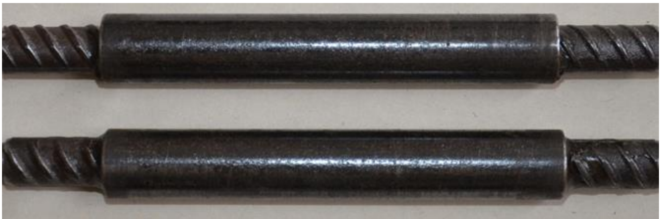
Рис. 9. Склеєне з'єднання арматурні стрижні - гільза в зборі.
