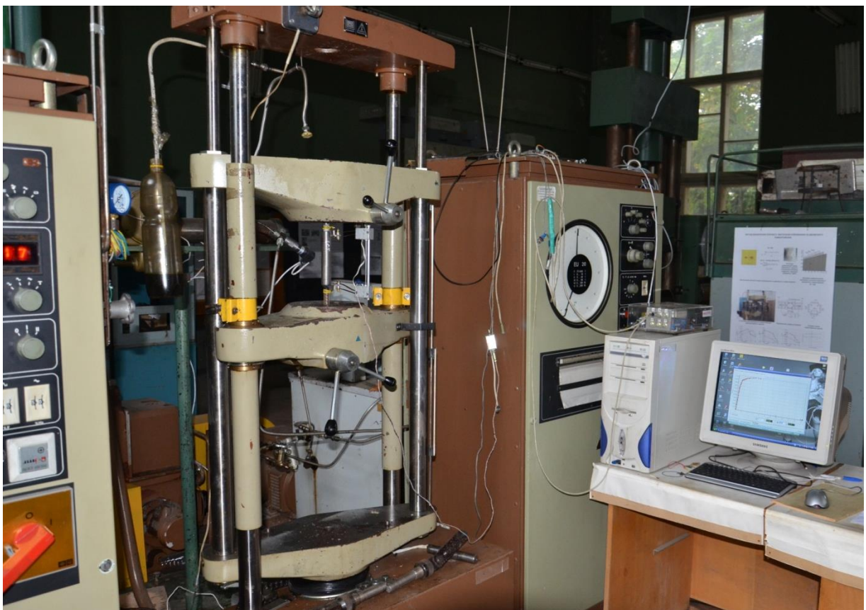
Рис. 11. Загальний вигляд 25-ти тонної розривної машини марки РМ-25 для осевого розтягу склеєного з'єднання арматурні стрижні – гільза та запис діаграми сила-деформація (P-ε) в процесі його руйнування
