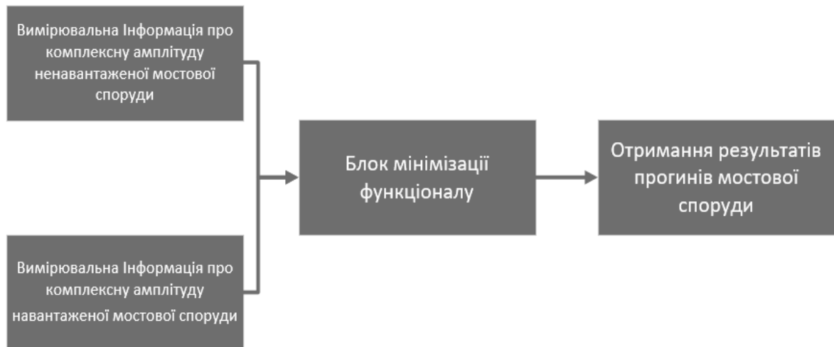
Рисунок 3.13 – Схема системи збирання і оброблення інформації про просторові прогини нижньої поверхні мостових споруд
