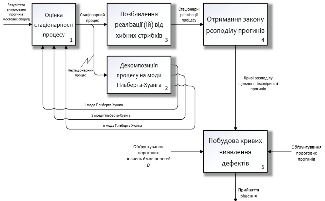
Рисунок 3.19 – Схема ІТ прийняття рішень про стан МС при обробленні нестаціонарних випадкових процесів прогинів (нотація IDEF0)
