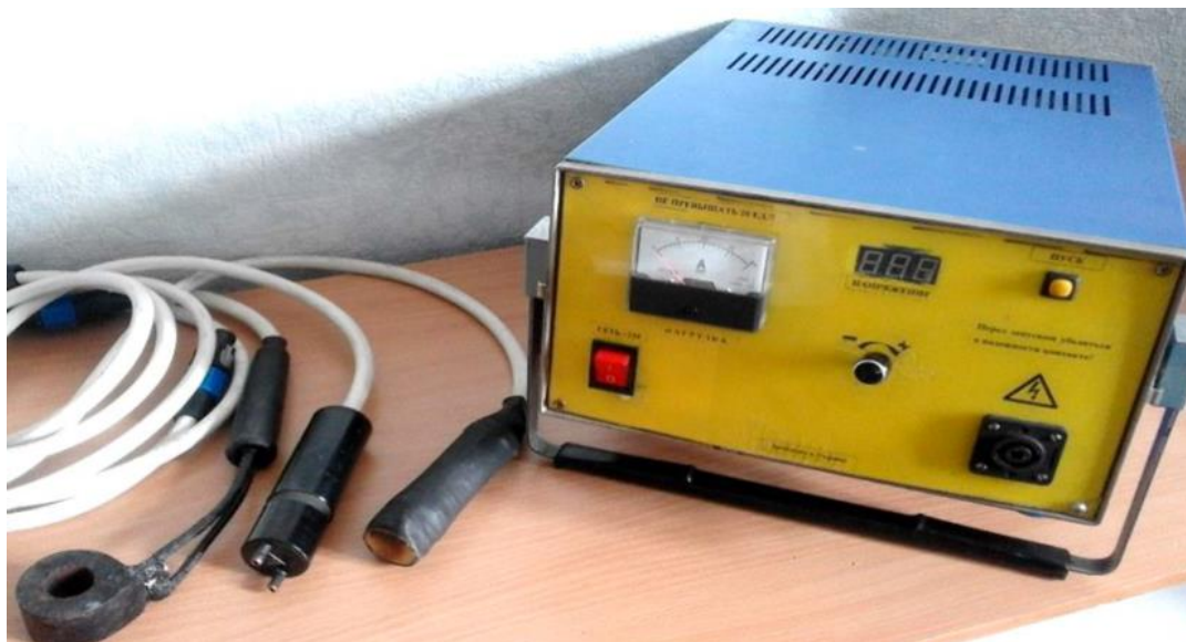
Рис. 4.2. Зовнішній вид «джерела №2», Електричні параметри: Живлення: мережа 220 В – 50 Гц; Максимальна вихідна потужність: 4 кВт; Діапазон регулювання потужності: 0...4 кВт; Робоча частота: 20 кГц.
