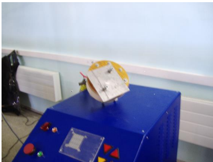
Рис. 4.23. Загальний вид: джерело потужності МІУС–2 із інструментом притягання та листовим зразком з вм'ятиною, що підлягає видаленню
