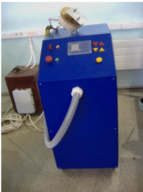
Рис. 4.21. Магнітно-імпульсна установка МІУС-2 з максимумом накопичуваної енергії \sim 2,4 кДж при напрузі \sim 2 кВ
