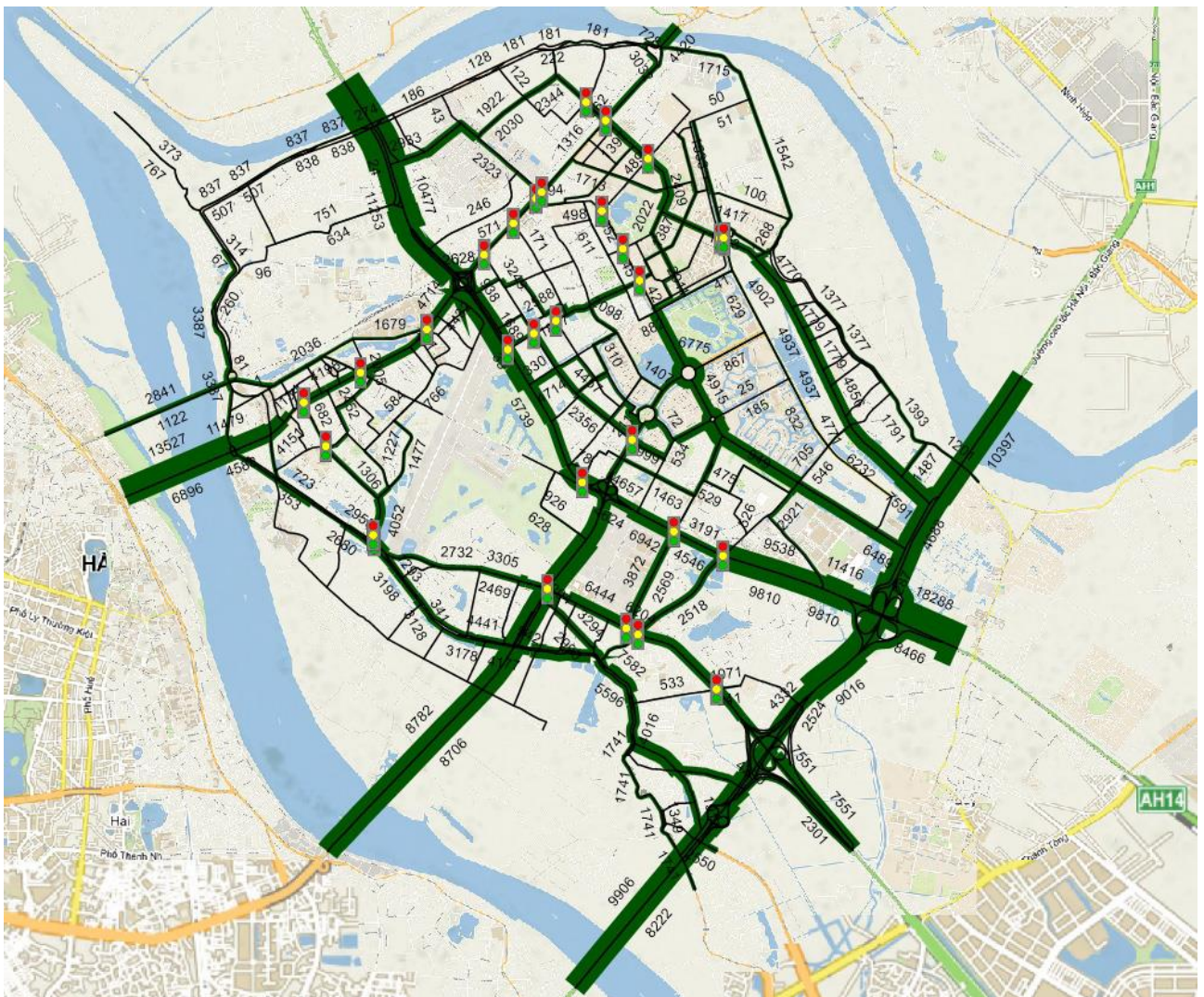
Рисунок 4.11 – Розподіл ТП в районі Лонгб'єн м. Ханой при використанні раціональних світлофорних циклів
