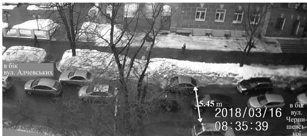
Рисунок 3.6 – Умови проведення експерименту з оцінки впливу ширини проїзної частини на швидкість руху автомобілів
