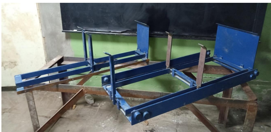
Рисунок 3.12 – Встановлення ножів та скребків на пересувній каретці
