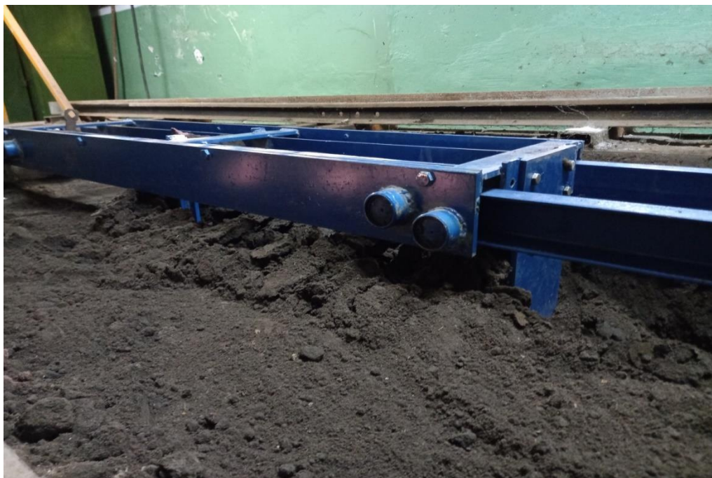
Рисунок 3.25 – Процес руйнування ґрунту ножово-скребковою секцією робочого обладнання
