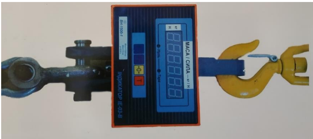
Рисунок 3.4 – Загальний вигляд електронного динамометра ВН-1500-1 з інтерфейсом налаштування на ґрунтовому каналі
