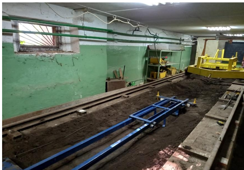
Рисунок 3.13 – Установлення випробувального обладнання на ґрунтовому каналі та визначення сил опору різання ґрунту ножово-скребковими секціями
