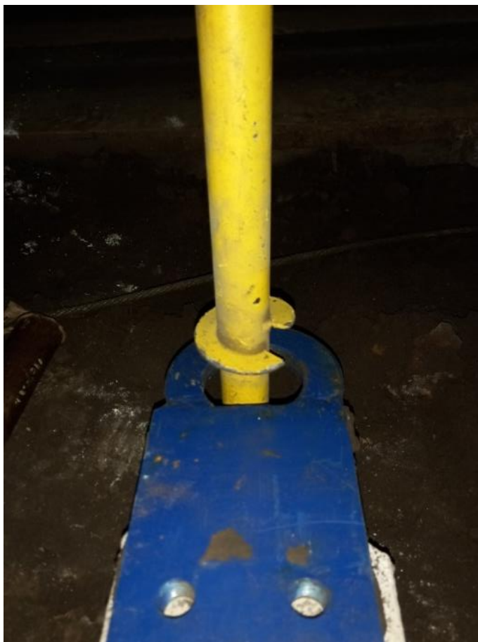
Рисунок 3.10 – Анкерне кріплення напрямних стендового обладнання до ґрунту
