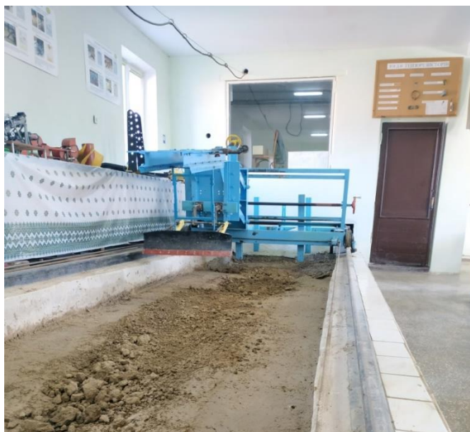
Рисунок 3.1 – Загальний вигляд ґрунтового каналу з тензометричним візком на кафедрі будівельних, дорожніх, меліоративних, сільськогосподарських машин і обладнання НУВГП
