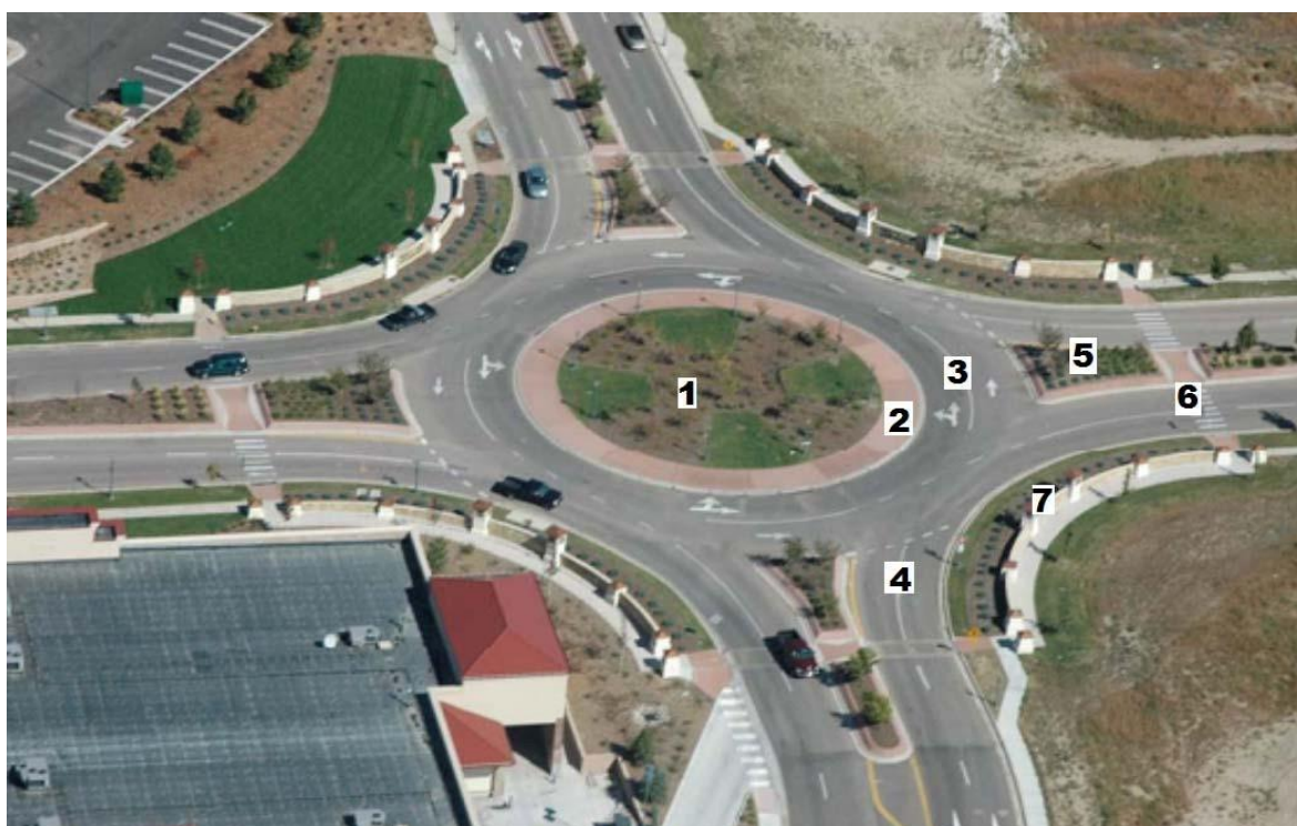
Рисунок В.2 – Основні елементи сучасного кільцевого перетину (1 – припіднятий центральний острівець; 2 – апро́н ( apron, truck apron ); 3 – кільцева проїжджа частина; 4 – двосмуговий вхід на кільцеве перетин із розміткою yield (поступися дорогою); 5 – припіднятий розділювальний острівець ( splitter island ); 6 – пішеходний перехід; 7 – ландшафтний буфер
