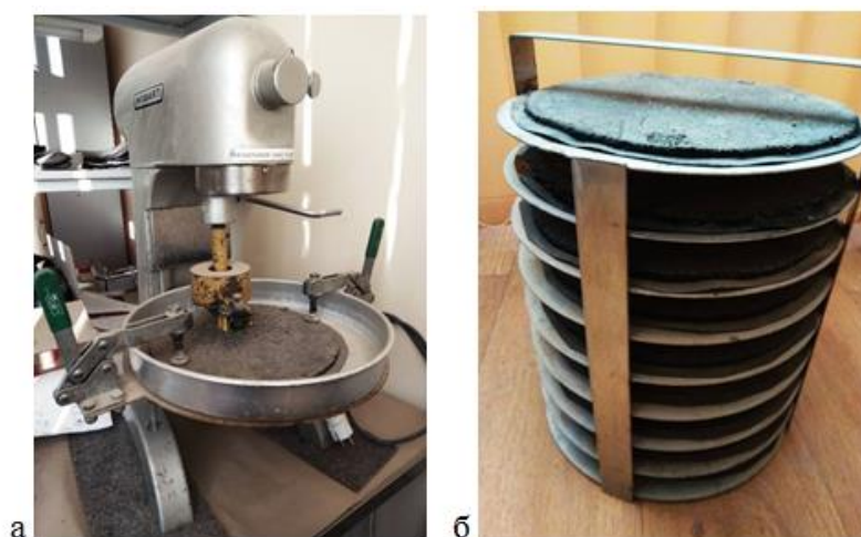
Рис.10 а – планетарний змішувач «Hobart C-100»; б – готові зразки
