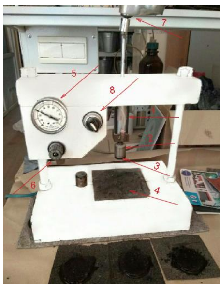
Рис.8. Модифікований когезійний прилад: 1 – повітряний циліндр;
