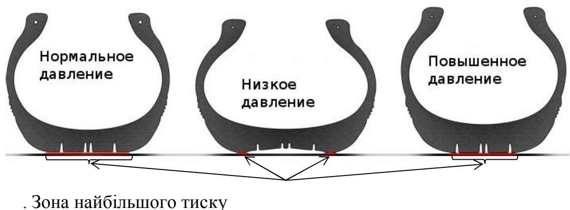
Рис.3. Пляма контакту шини з поверхнею в залежності від тиску в ній [10]
