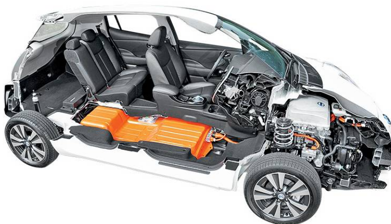
Рисунок 1.8 – Розміщення літій-іонної акумуляторної батареї в електромобілі Nissan Leaf
