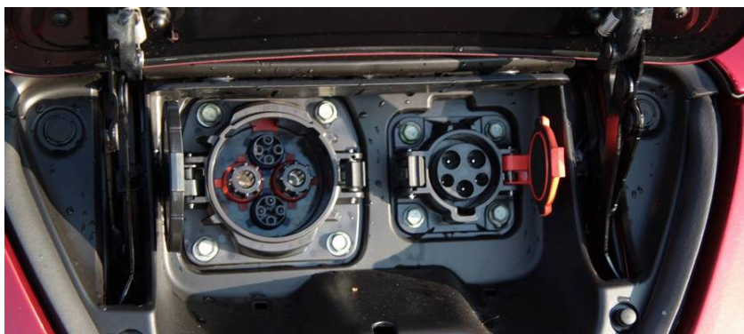
Рисунок 1.9 – Роз'єми для заряду електромобіля Nissan Leaf
