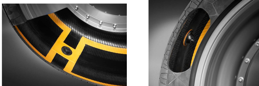
Рис. 2.5. Шина Continental з ContiSense and ContiAdapt
