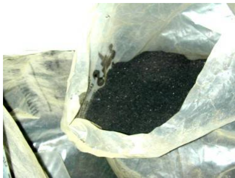
Рис. 3.3. Гумовий порошок з дисперсністю 50 – 200 мкм очищається від залишків металу і текстильного корду
