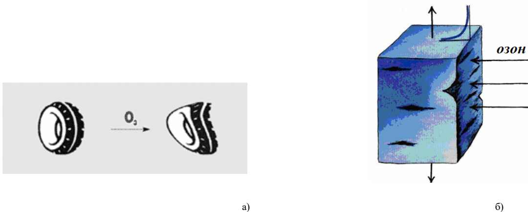
Рис. 5.2. Зразок а - розтріскування гумових відходів під дією озону; б - деформації гумових відходів під дією озону
