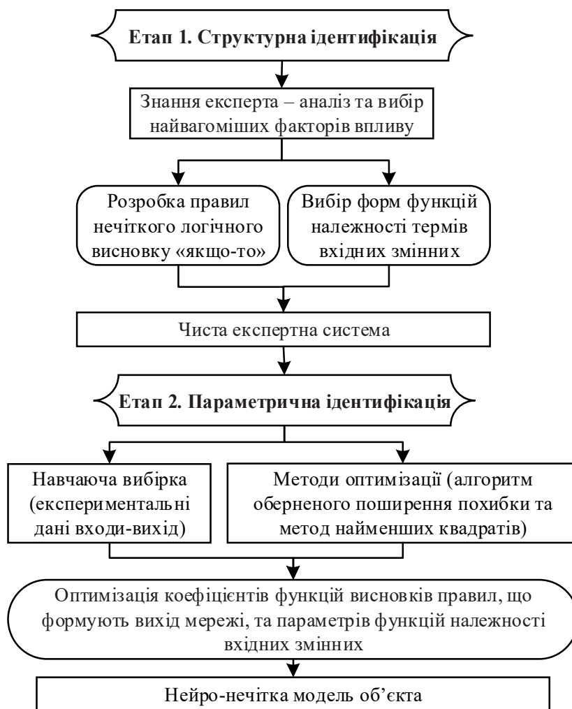
Рисунок 2.1 – Етапи налаштування системи оцінювання коефіцієнта зчеплення
