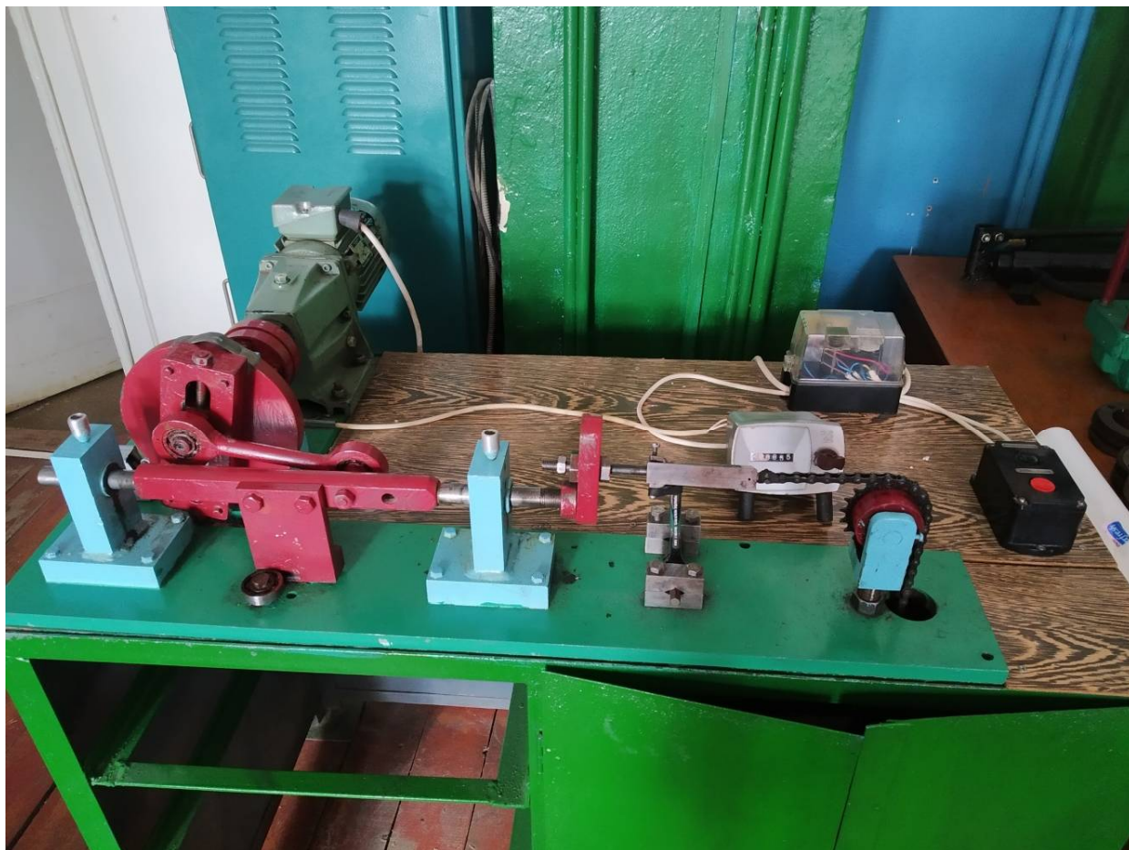
Рис 2.7 – Випробування ключів під навантаженням на спеціально виготовленому стенді для ресурсних випробувань гайкових ключів
