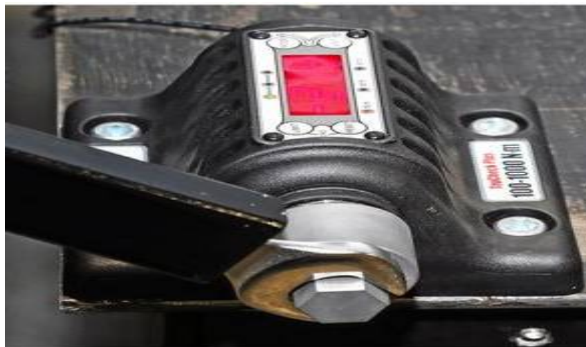
Рис. 2.9. – Випробування ключів торсіометром TruCheck Plus 1000 Нм.
