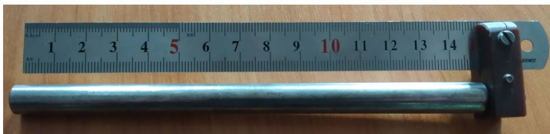
Рис. 3.1. – Приспособлення для визначення дійсних розмірів відкритого зіву і кільця: а – лінійка-клин: 1 – лінійка; 2 – корпус; 3 – клин; б – лінійка-конус: 1 – лінійка; 2 – корпус; 3 – конус.
