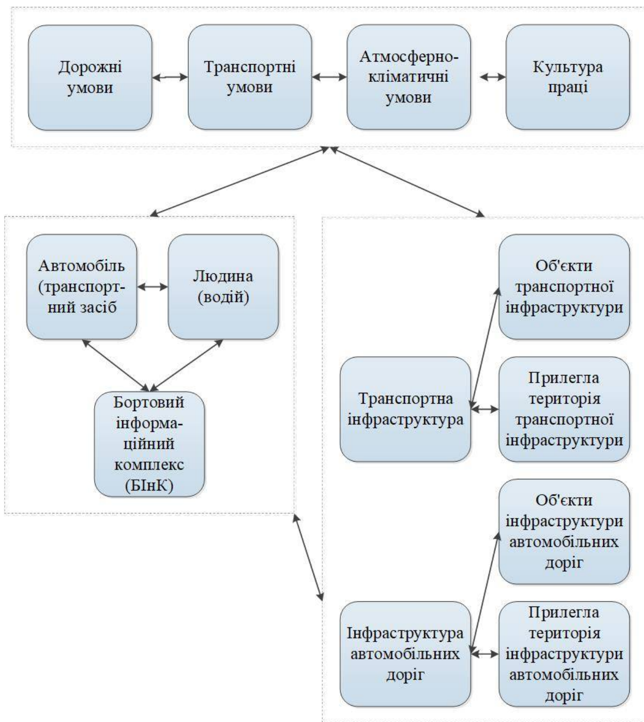
Рисунок 2.1 – Загальна схема системної взаємодії системи АБУІТА в умовах ITS
