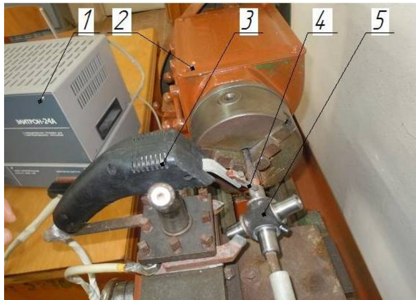
Рисунок 6.4 – Стенд для нанесення електроіскрового покриття
