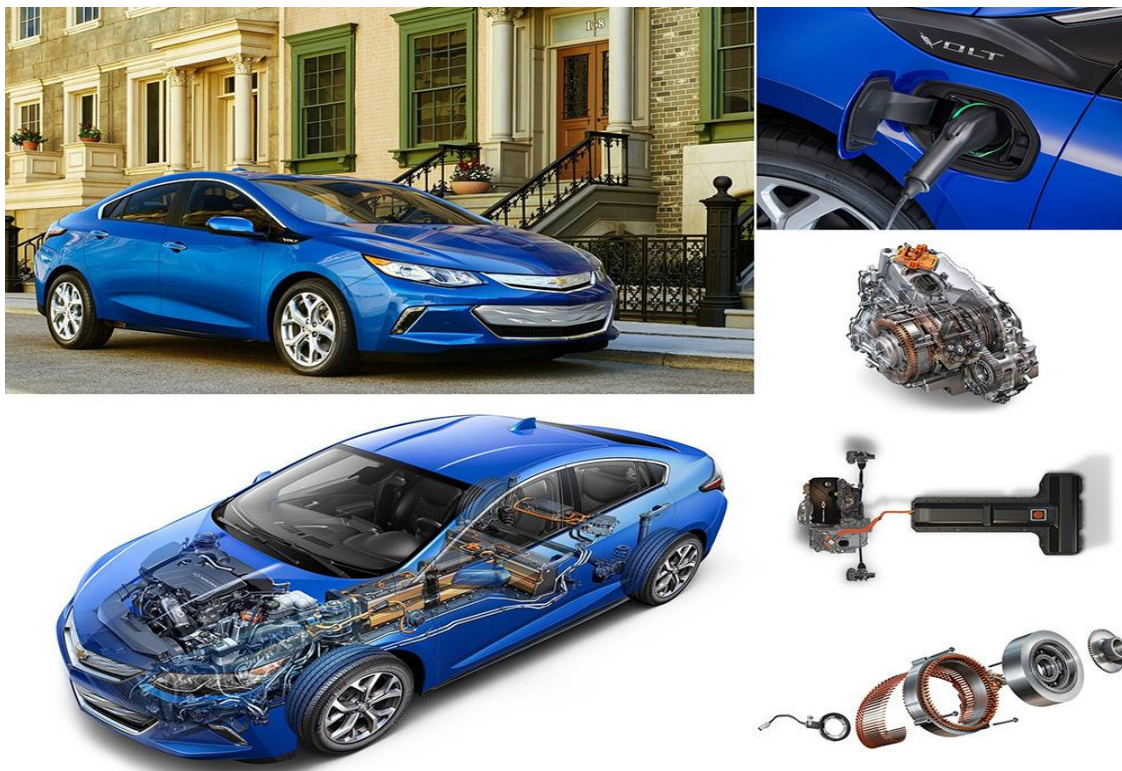
Рисунок 2.3 – Chevrolet Volt – гібридний автомобіль з послідовною схемою [7].
