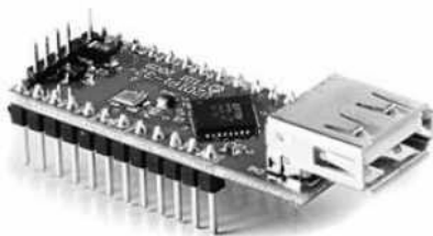
Рисунок 2.3.1 – Блок накопичення інформації ІДС на основі хост-контролера VNC2
