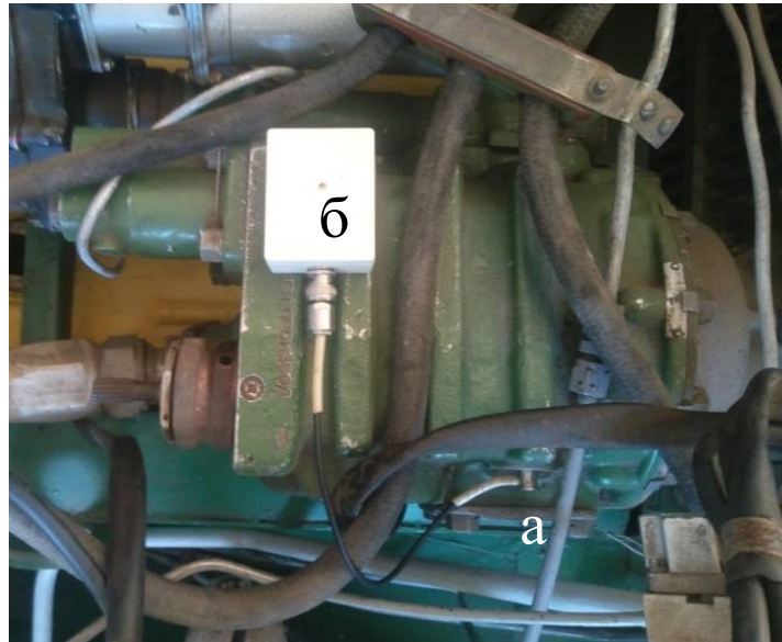
Рисунок 5.2 – Варіант встановлення інформаційно-діагностичної системи на насосі НП-52М: а – датчик АЕ; б – прилад на основі методу АЕ
